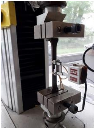
Figure 102 Mise en place de l'éprouvette et de l'extensomètre pour un essai de traction
