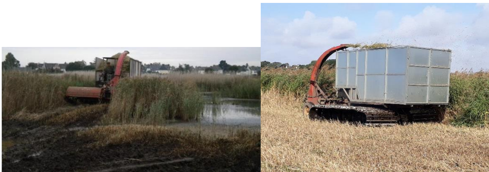
Figure 18 Photos d'une dameuse modifiée pour la récolte du roseau, © C. Danilo
