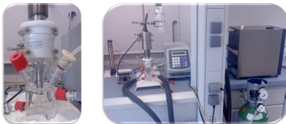
Figure 23 : Photographies du montage du réacteur sonochimique à basse fréquence ultrasonore (20 kHz).
