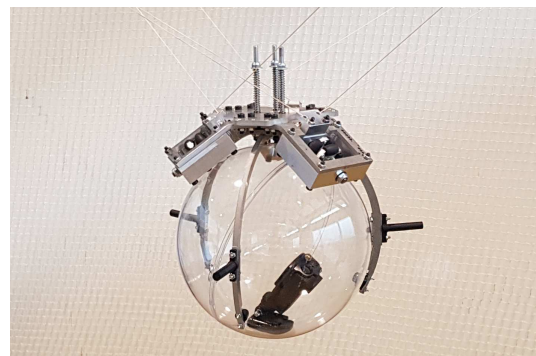
(d) Manufactured parallel spherical wrist, [Mét19]
