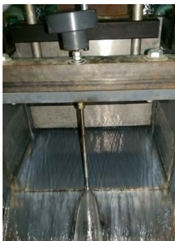
Figure 3.3 – La vanne guillotine à 0.2 m à l'amont de la sortie du canal du débit conservé Q_{x0} .
