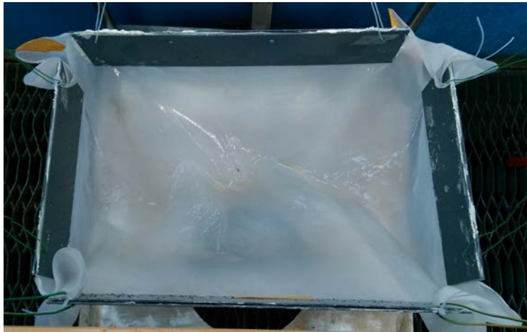
Figure 6.7 – Le manchon sur mesure utilisé pour piéger les particules de verre expansé du déversoir latéral.
