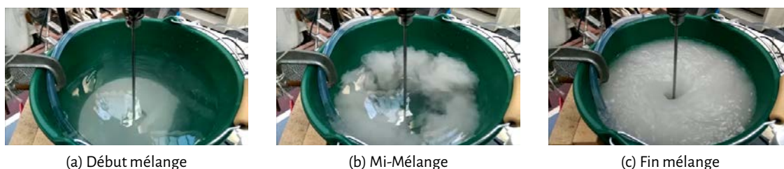
Figure 6.3 – Le mélange des particules en verre expansé avant injection.
