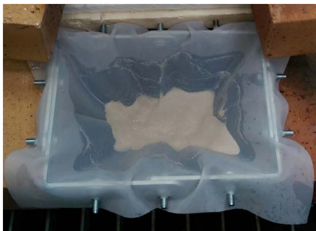
Figure 6.8 – Exemple de tamis en polyester de taille réduite (même maille de 33\ \mu\text{m} ) pour mesure de la masse déversée par l'un des canaux du déversoir latéral.
