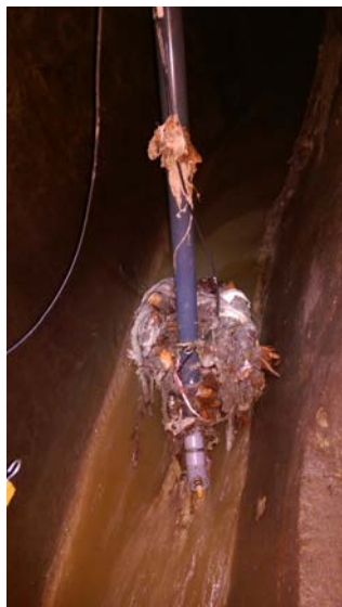
Figure 7.4 – Exemple des macro déchets accrochés au système de support de la sonde de turbidité et de prélèvement pour la section de mesure « Amont ».
