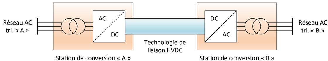
FIGURE B.1 – Structure générale d'une liaison « point-à-point » HVDC.
