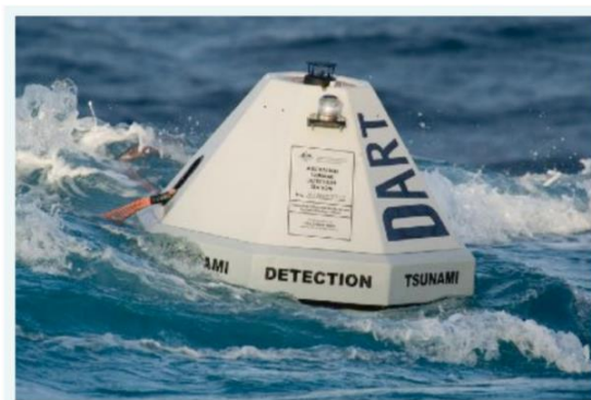
Figure 44 : Photographie d'une bouée DART® (Source : EDUMED ; Crédit photo NCAA)
