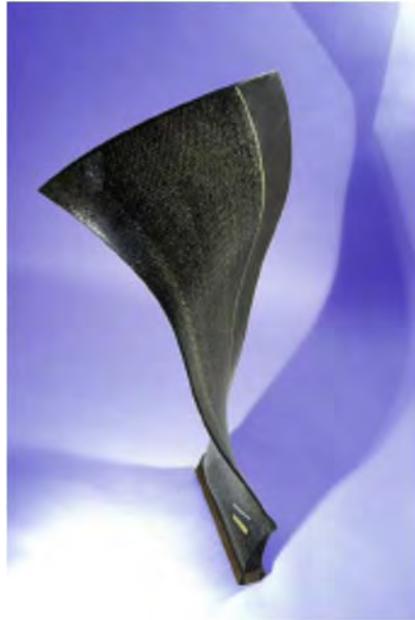
Fig. 1.1 Aube de moteur d'avion (Snecma, Groupe Safran) [MAT15]
