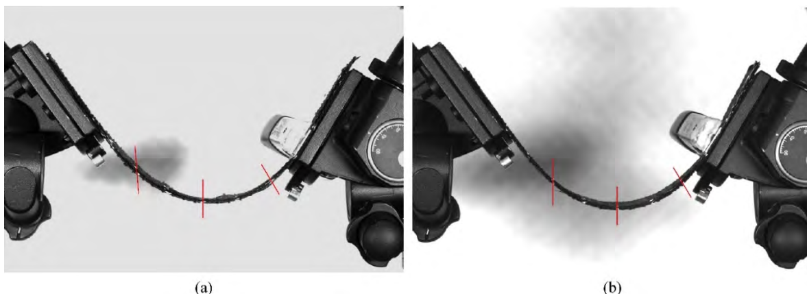
Fig. 4.6. Flexion avec une seule extrémité encastree dans le cas de 2 couches G1151 (a) Trame (b) Chaîne
