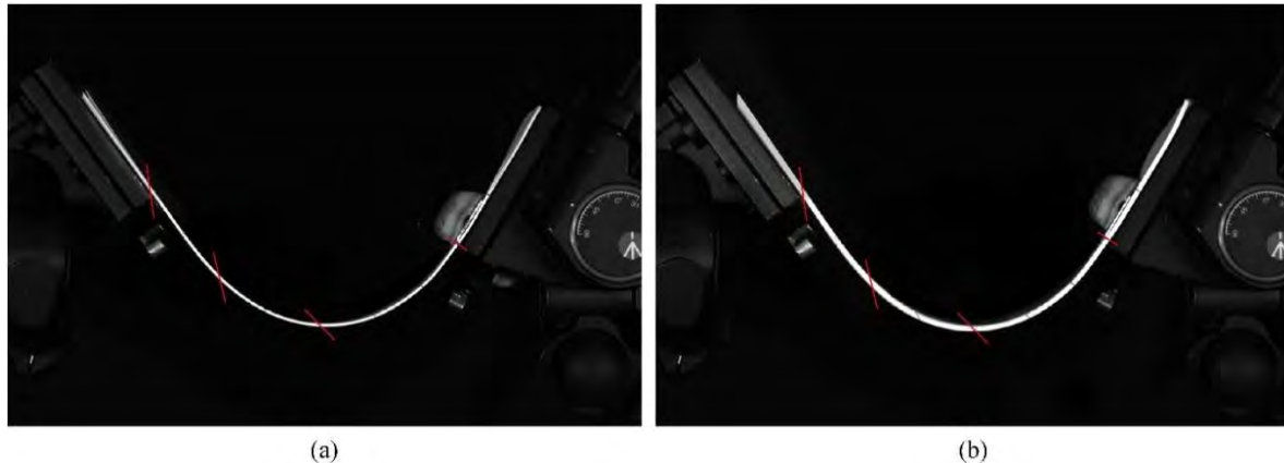
Fig. 4.5. Flexion avec une seule extrémité encastree (a) 10 couches papiers (b) 20 couches papiers
