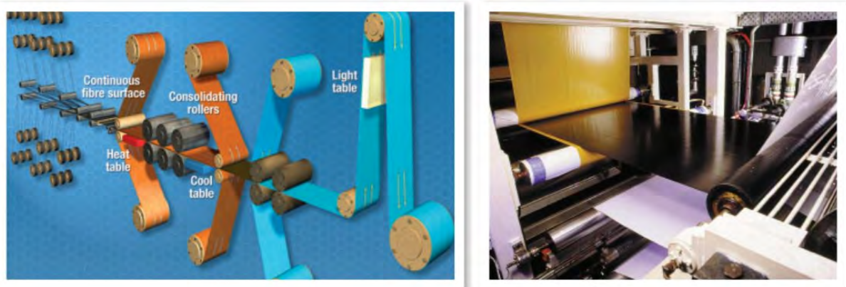
Fig. 1.8. Fabrication de Prepregs [HEXCEL b]
