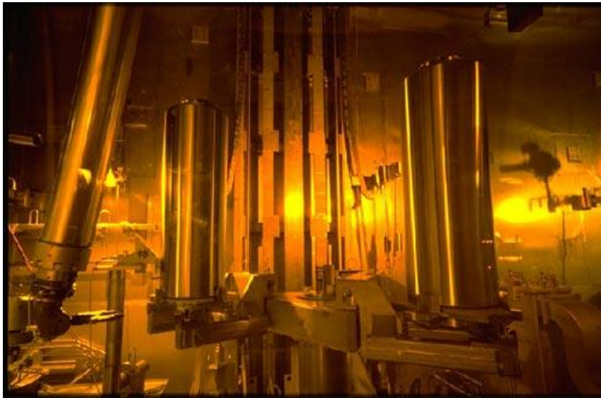
Figure 8.1. À gauche – Remplissage des conteneurs HA de verre.
