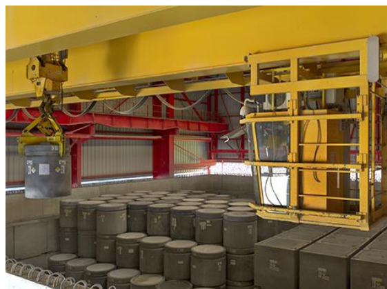
Figure 7.1. Ci-dessus – Déchets conditionnés au CSA et placés dans un ouvrage.
