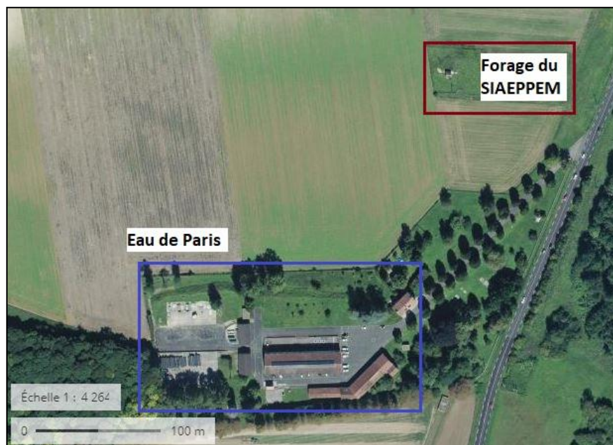
Figure 8.11 – Emplacement du captage du SIAEPPM par rapport à l'usine d'Eau de Paris à Longueville. Les deux réseaux sont totalement distincts et associés à une qualité de l'eau très différente. L'usine de Longueville traite les pesticides des eaux de la Voulzie, du Durteint et du Dragon qui sont ensuite acheminées jusqu'à Paris après avoir été mélangées à d'autres eaux. L'eau puisée par le SIAEPPM est distribuée aux habitant.e.s sans que les nitrates ou les pesticides soient traités : l'eau n'est pas conforme. Source : Géoportail (IGN).
