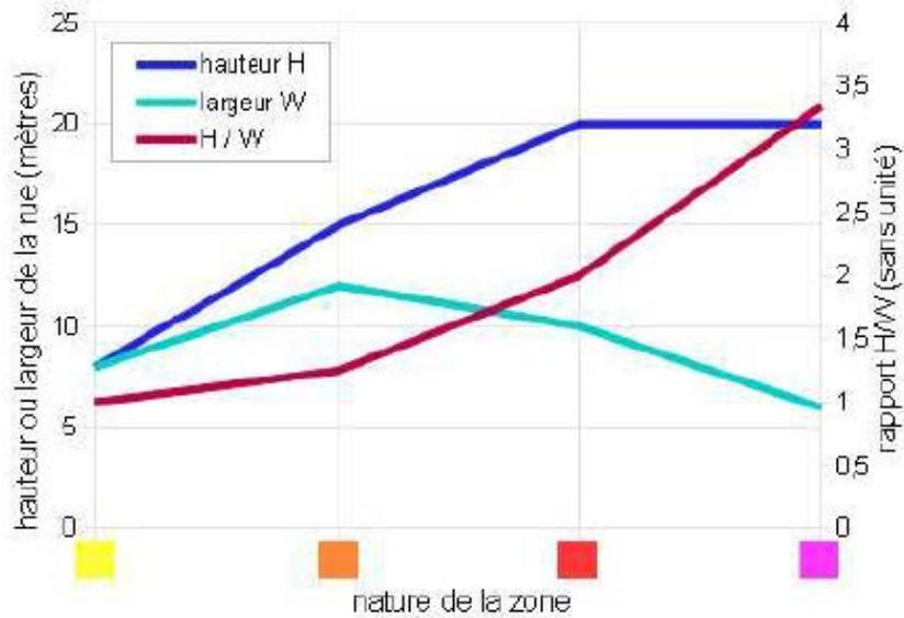
FIGURE 2.20 – Etude du rapport d'aspect des rues de Lyon réalisée à partir de l'analyse de la figure précédente (figure 2.19), extrait des travaux de Patriarche [10].
