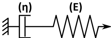
FIGURE 3.18 – Schéma rhéologique d'un modèle de Maxwell.
