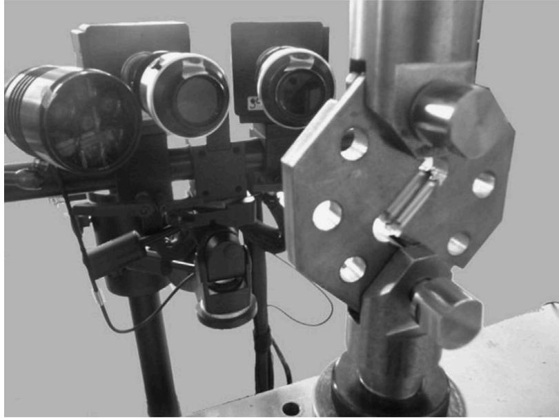
FIGURE 1.40 – Exemple de dispositif expérimental proposé par Créac'hcadec [61]. Le dispositif Arcan monobloc est adapté sur une machine de traction par un système de goupilles et les déplacements mesurés par stéréo corrélation d'images.
