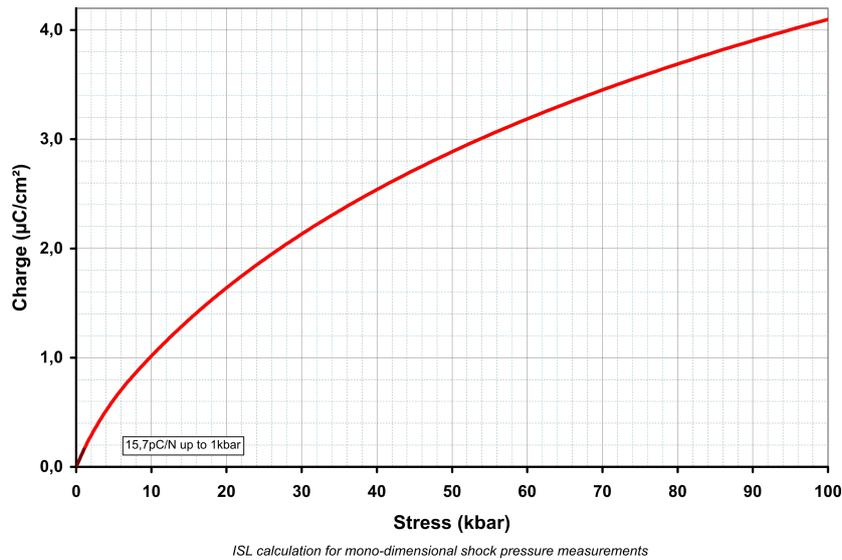
FIGURE D.1 – Courbe de la relation charge surfacique et la pression pour une jauge PVDF de type Bauer Shock Gauge. En dessous de 100 MPa, cette relation est linéaire. Image issue du manuel d'utilisation de la jauge par Bauer [6].
