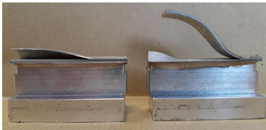
FIGURE 5.13 – Assemblage substrat/lamelle au maximum de l'énergie laser possible.
