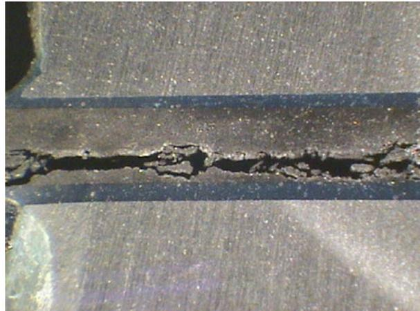
FIGURE 1.43 – Exemple de rupture dans un composite généré par Arcan modifié [63]
