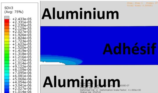
FIGURE 4.39 – Motif d'endommagement pour une énergie laser de 70% de  $E_{max}$ , estimé par un critère de Nikiphorovski-Shemyakin, à  $t = 0.54 \mu s$
