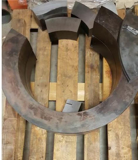
Figure 3-36 : Trois quarts de viroles soudées (diamètre extérieur 546 mm)
