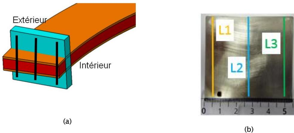
Figure 3-39: Positions des lignes d'indentation
