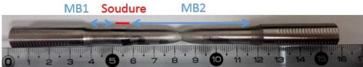
Figure 3-52: Eprouvette RL3 après essai de traction jusqu'à rupture
