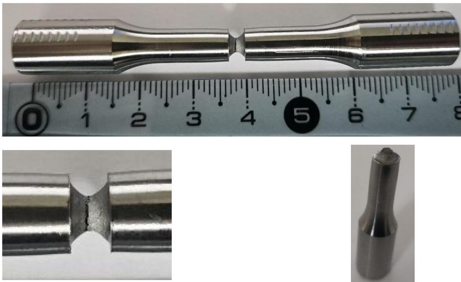
Figure 3-16: Vue de la rupture finale d'une éprouvette cylindrique entaillée
