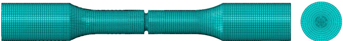
Figure 4-1: Maillage régulier de l'éprouvette entaillée avec des éléments de taille 0,5 mm<sup>3</sup>
