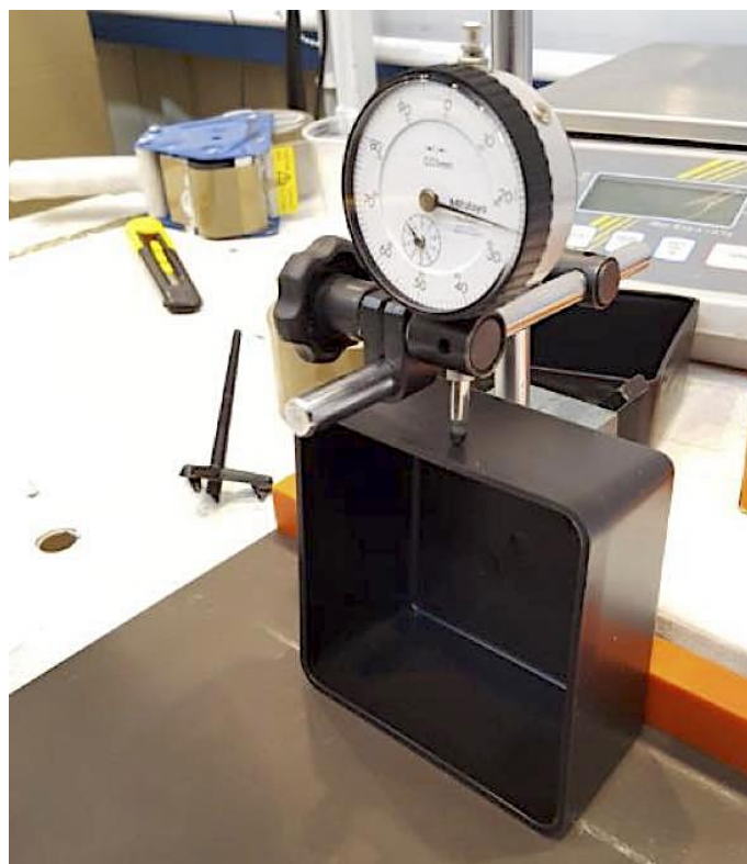
Figure 2.1 – Mesure d'une dimension géométrique de la boîte noire à l'aide d'un comparateur.
