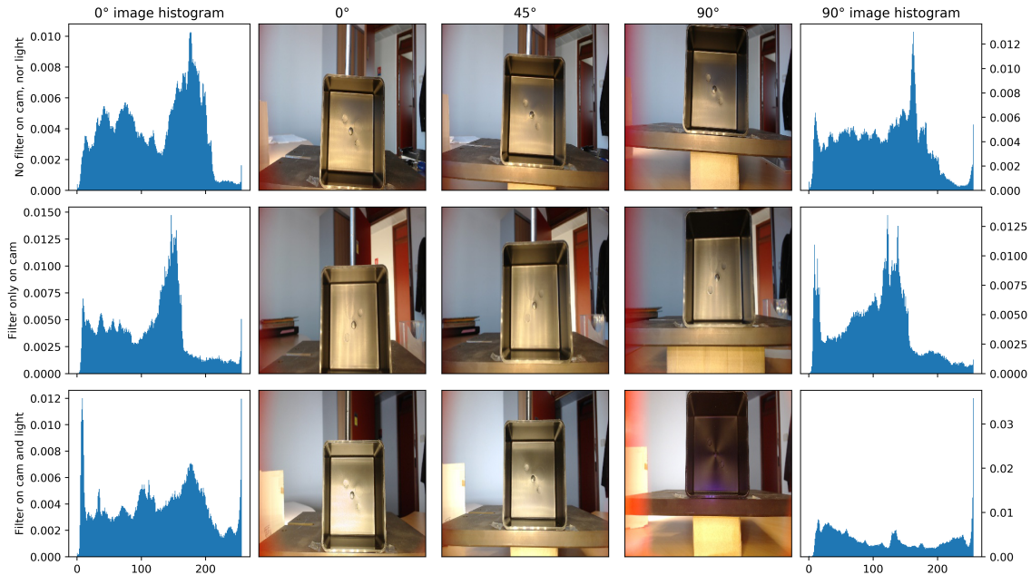
Figure 2.12 – Images de la même pièce par les 3 caméras, sous 3 angles de polarisation différents.
