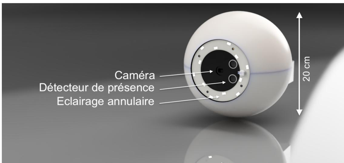
Figure 4.1 – Rendu réaliste du dispositif de mesure proposé.
