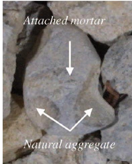
Figure I. 5 : Compositions des granulats recyclés de béton.
