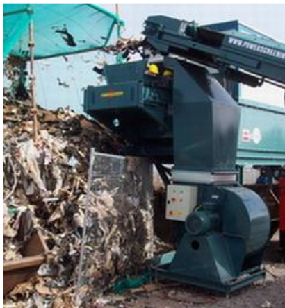
Elimination des matériaux légers par jet d'air
