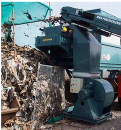
Elimination des matériaux légers par jet d'air
