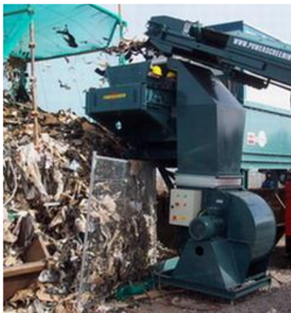
Elimination des matériaux légers par jet d'air
