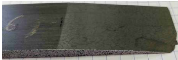
FIGURE II.4 – Exemple de biseau de 45 mm de long en extrémité d'éprouvette [13]
