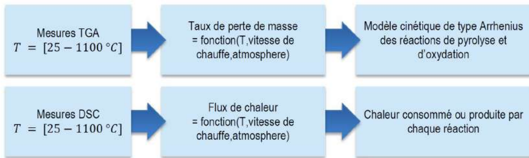
FIGURE I.7 – Principe des mesures couplées TGA et DSC [7]
