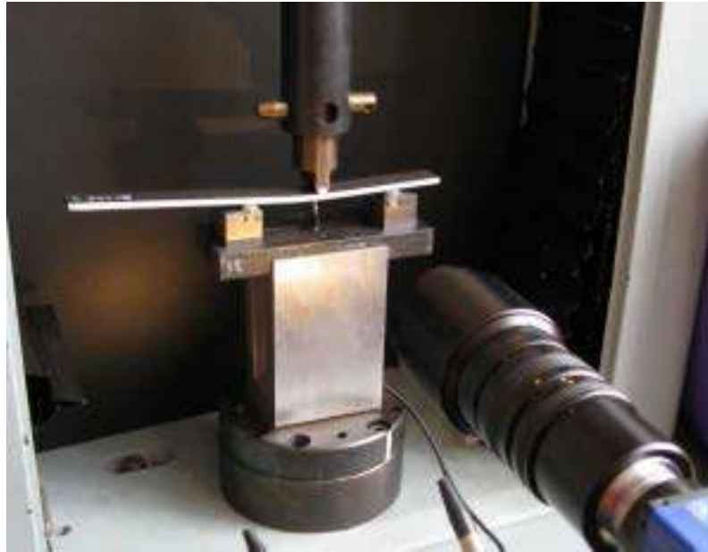
FIGURE I.29 – Essai ENF pour des composites stratifiés [24]
