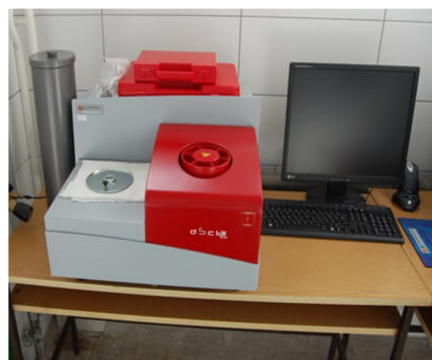
b : Photo du calorimètre DSC
