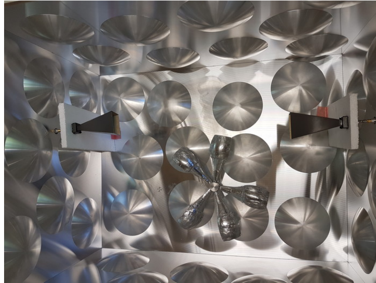
FIGURE D.2 – Deux antennes cornet en visibilité direct et même polarisation à l’intérieur de la CRC.
