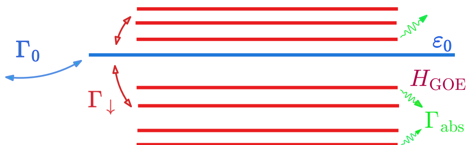
FIGURE D.1 – Schéma de modèle Hamiltonien, le seul niveau \epsilon_0 est couplé aux canaux de diffusion et le background chaotique H_{GOE} conduisant respectivement aux taux de décroissances \Gamma_0 et \Gamma_{\downarrow} . Les états H_{GOE} ne sont pas directement connectés aux canaux, ils peuvent avoir un uniforme élargissement \Gamma_{abs} pour tenir compte des pertes homogènes.
