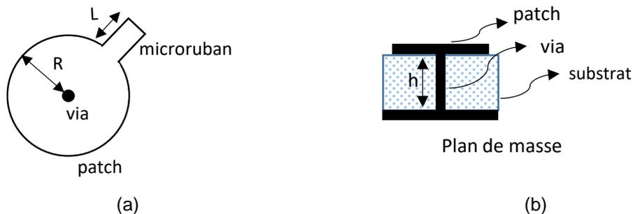
Fig. 2.8. Cellule élémentaire de type patch, (a) vue de dessus, (b) vue de côté.
