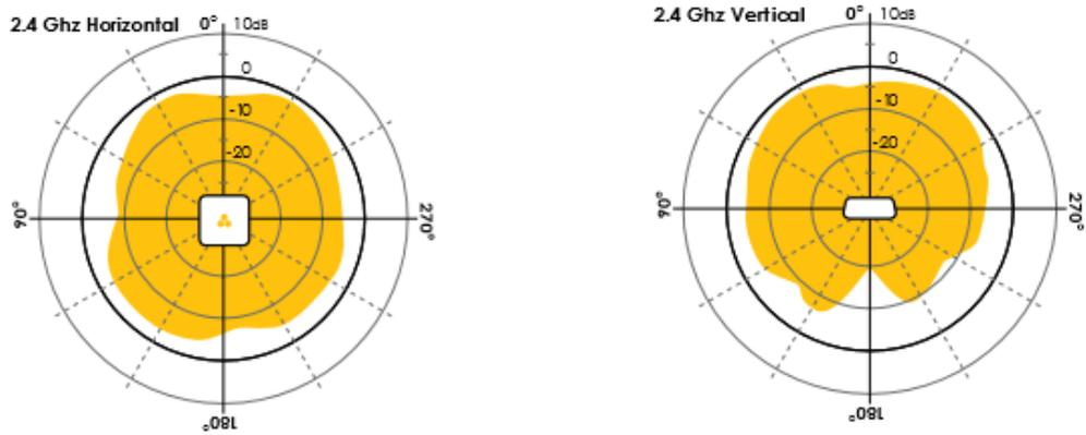
Fig. 4.18. Diagramme de rayonnement de l'antenne d'émission AP120.
