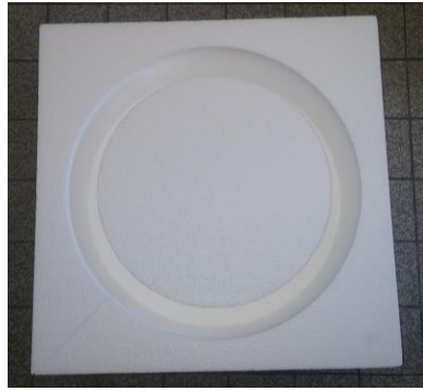
Figure III-5 : coffrage en polystyrène pour les anneaux en béton
