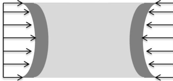
Figure III-25 : schéma explicatif de l'hypothèse d'une poussée non uniforme du vérin qui induirait une flexion longitudinale de l'anneau – Coupe transversale de l'anneau
