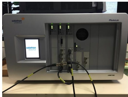
Figure 2.16 : Photographie du spectromètre d'impédance Solartron Modulab.
