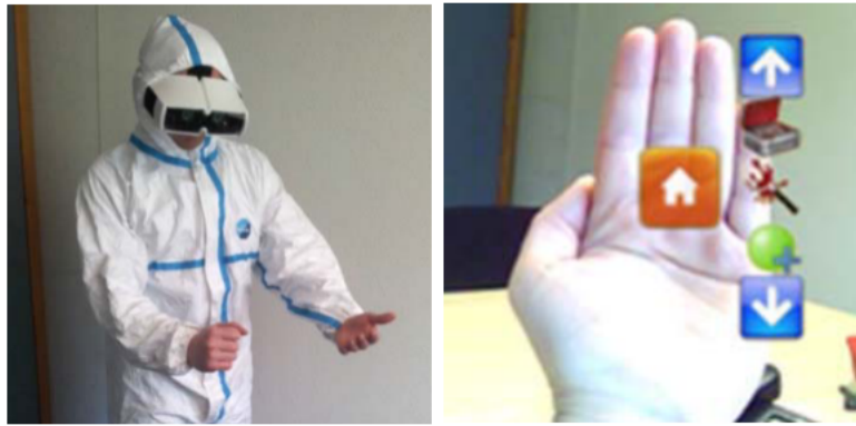
FIGURE 1.23 – Exemple de menu invoqué apparaissant grâce à des gestes manuels. Image issue de [52].
