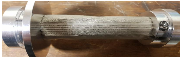
Figure 3.30 : Gaine avec Over-lap
