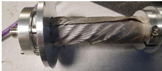
Figure 3.20 : Assemblage de la cellule triaxiale et la gaine
