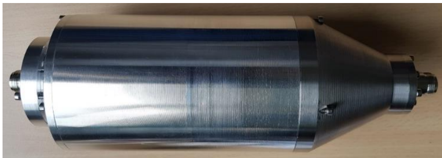
Figure 3.42 : Cellule Triaxiale fabriquée avec adaptation
