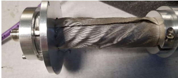
Figure 3.24 : Assemblage de la cellule triaxiale avec la gaine
