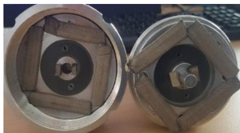
Figure 2.57 : Utilisation des mousses conductrices.
