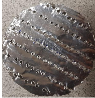
Figure 3.37 : Plaque ALU 0.1 mm avec trous pour la mesure en cellule triaxiale coaxiale
