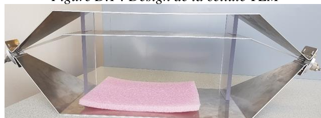
Figure D.2: Cellule TEM fabriquée (DC- 1 GHz)
