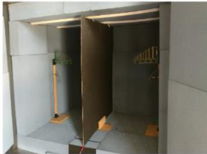
Figure 1.18: Intérieur d'une boîte anéchoïque [6]
