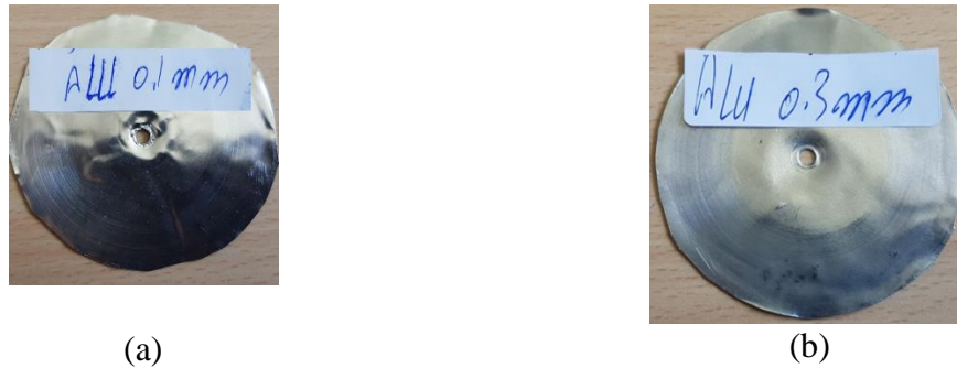
Figure 2.68 : Plaque en ALU avec épaisseur de, 0.1 mm(a) et 0.3 mm (b)
