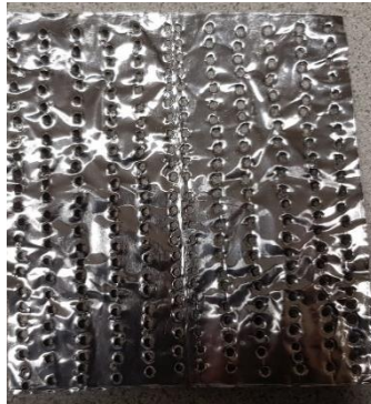
Figure 3.55 : Plaque ALU 0.1 mm avec trous pour la fabrication de la gaine
