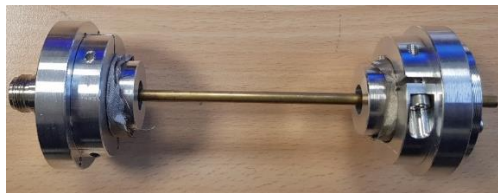
Figure 3.25 : assemblage de la cellule triaxiale avec tissu en contact
