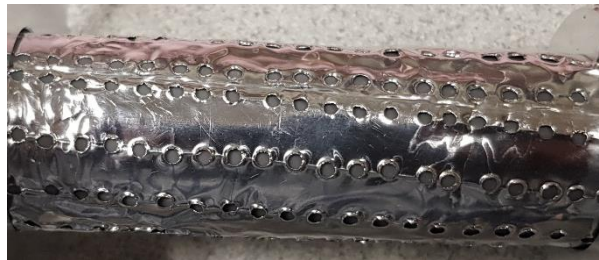
Figure 3.56 : Gaine fabriquée à partir de plaque ALU en 0.1 mm avec trous
