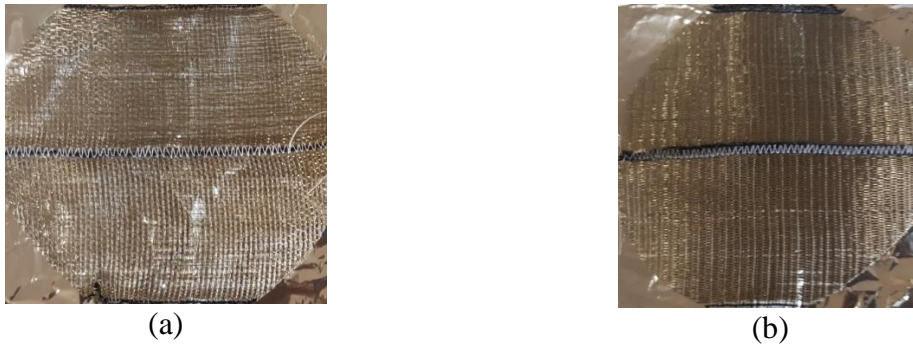
Figure 2.32 : Tresses en Cuivre Nickelé, (a) 220 fils, (b) 440 fils
