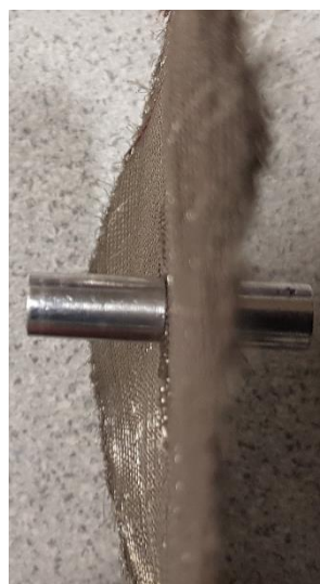
Figure 2.12 : Assemblage entre pin de connexion et échantillon sous test
