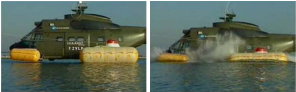
FIGURE 7.1 – Visualisation des flotteurs lors de tests à taille réelle réalisés par Airbus Helicopters [62].
