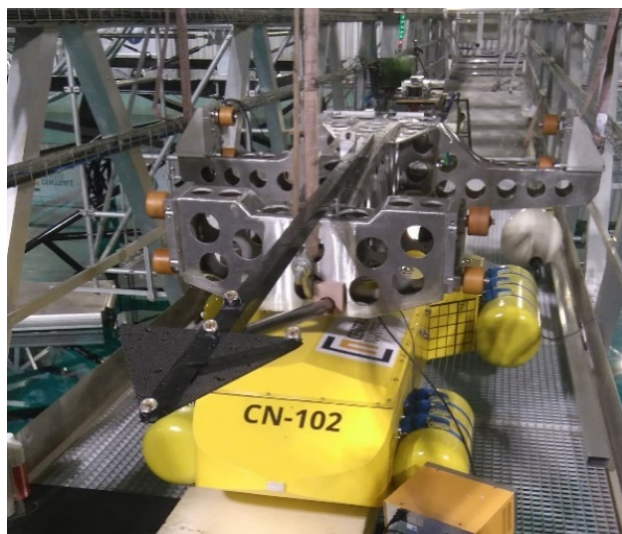
FIGURE 7.3 – Vue de la maquette de l'hélicoptère et du charriot qui lui est attaché.
