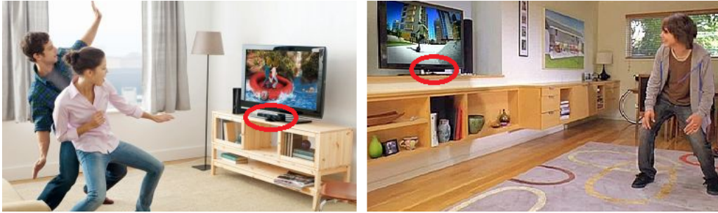
FIGURE 2.1 – La Kinect de Microsoft possède un capteur de profondeur qui lui permet de piloter la console de jeu vidéo X-Box avec les gestes du corps (Extrait de http://gamesidded.com (gauche) et http://www.lefigaro.fr (droite)). La Kinect est entourée en rouge sur les deux images.
