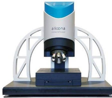
Figure II-50. Outil de mesure optique 3D Alicona finite focus.
