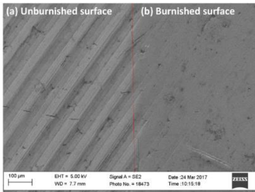
Figure I-69. Images MEB avant et après galetage (Uddin et al. , 2018).
