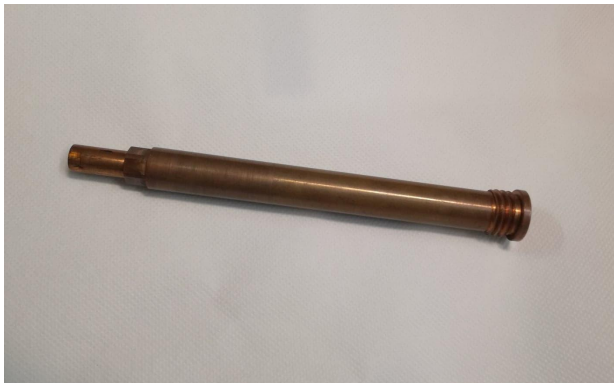
FIGURE 3.3 – Photos du doigt froid. Longueur environ 20 cm.
