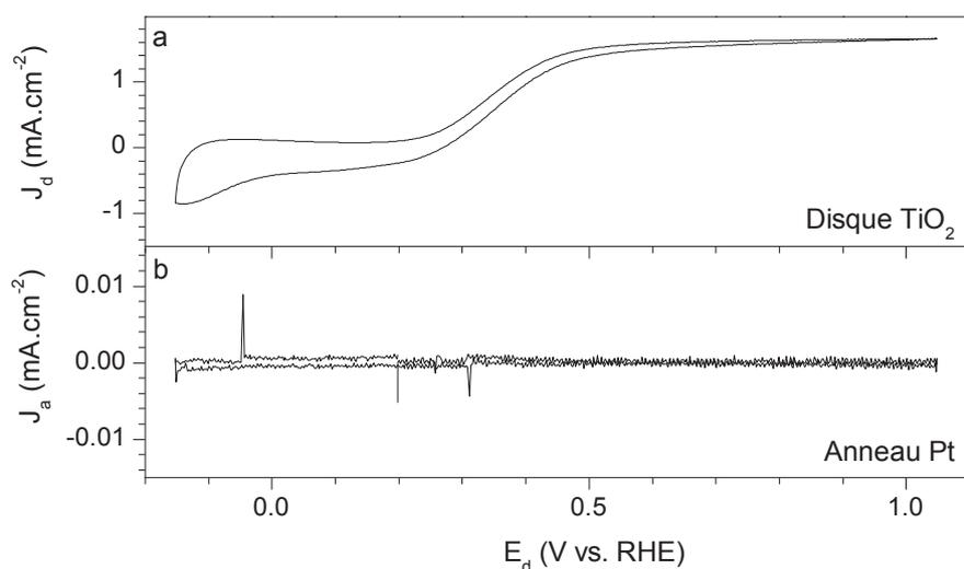
Figure A15 : (a) Voltammogramme du disque de TiO<sub>2</sub> sous illumination (1000rpm) et (b) courant enregistré sur l'anneau de Pt soumis à un potentiel de 1,348 V vs. RHE.
