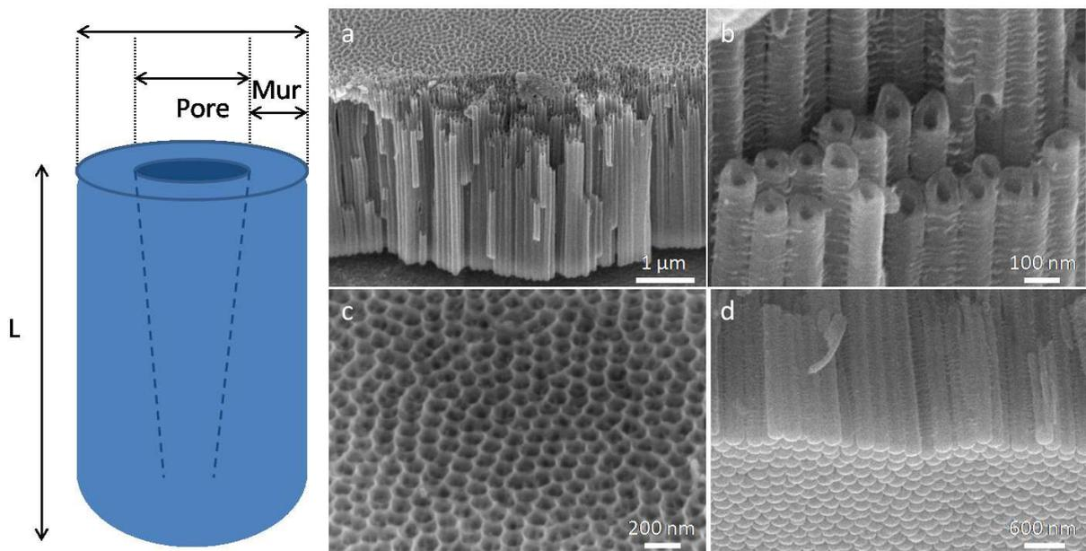
*Figure II.6 : Schéma des dimensions d'un nanotube (à gauche) et observation au MEB des nanotubes de TiO<sub>2</sub> calcinés à 500°C à une rampe de 5°C.min<sup>-1</sup> sur un porte-échantillon à 45°. (a) vue en tranche, (b) zoom sur les nanotubes, (c) vue de dessus et (d) vue de dessous*
