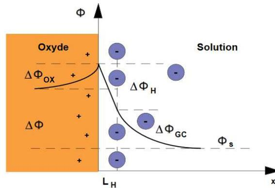
Figure I.17 : Variation du potentiel dans la zone de charge d'espace et la double couche électronique
