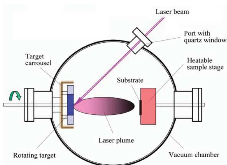
Figure IV.1 : Schéma descriptif de l'enceinte d'ablation laser pulsé
