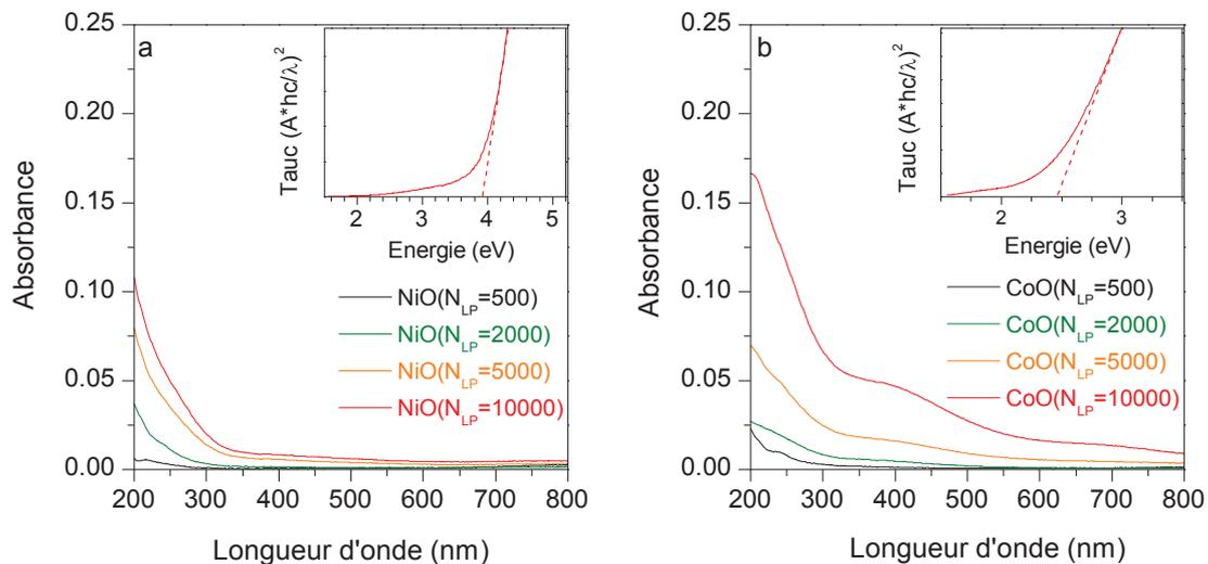
Figure IV.22 : Courbes d'absorbance de dépôts de (a)  $\text{NiO}$  et (b)  $\text{CoO}$  sur lames de quartz. Les inserts représentent les courbes de Tauc effectuées sur les échantillons à  $N_{LP}=10000$ .
