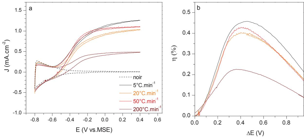
Figure II.24 : (a) Voltammogramme sous illumination avec la lampe Xénon ( $100\text{mW}\cdot\text{cm}^{-2}$ ) des nanotubes de  $\text{TiO}_2$  calcinés sous différentes rampe en températures (la courbe en pointillé représente le voltammogramme mesuré sans illumination) et (b) courbes de rendement correspondantes.
