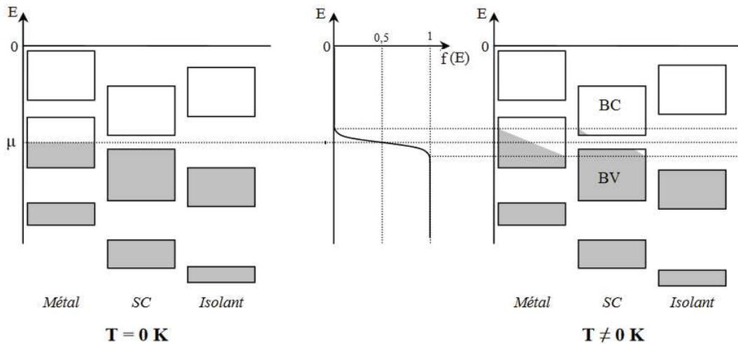
Figure I.13 : Schéma de la structure de bande des métaux, semi-conducteur, et isolant à  $T=0K$  (à gauche) et à  $T\neq 0K$  (à droite). La fonction de Fermi-Dirac est représentée au centre ( $T\neq 0K$ ).
