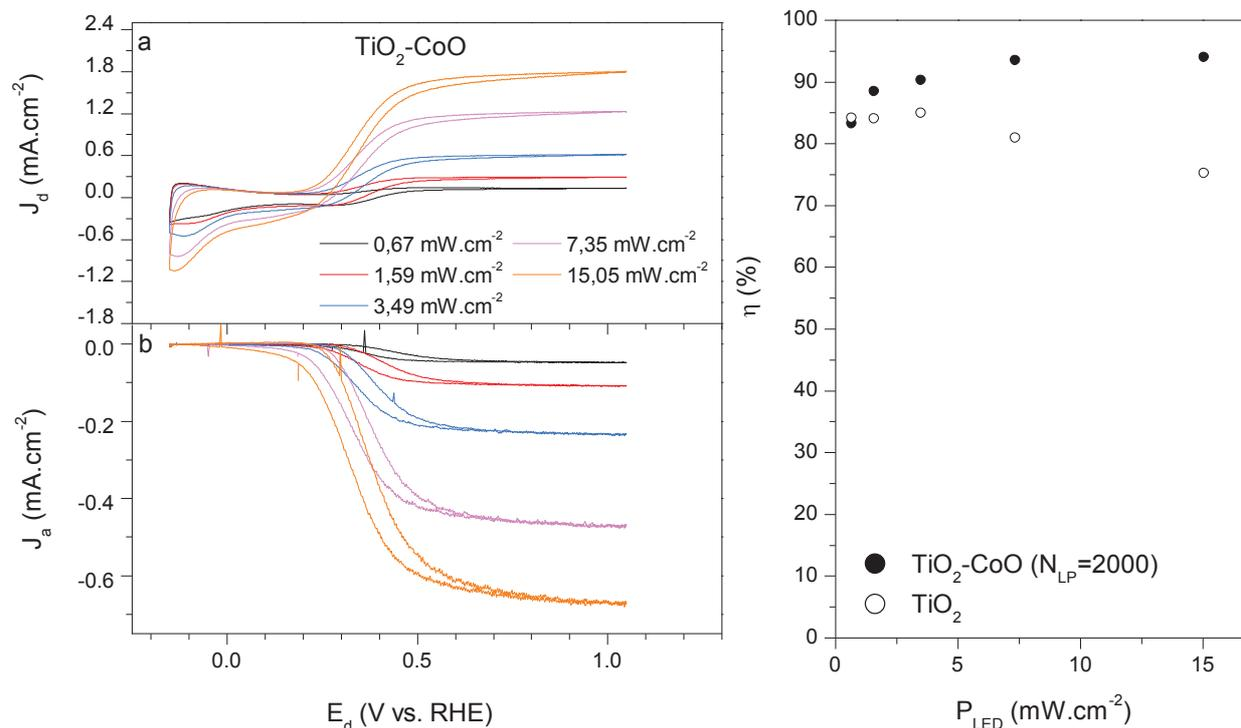
Figure A18 : (a) Voltammogrammes du disque de  $\text{NT}_5$  de  $\text{TiO}_2$  avec dépôt de  $\text{CoO}$  ( $N_{\text{LP}}=2000$ ) à différentes puissances de LED avec (b) courant correspondant sur l'anneau. (c) Rendement faradique du plot  $\text{TiO}_2\text{-CoO}$  et du plot de  $\text{TiO}_2$  pour comparaison.
