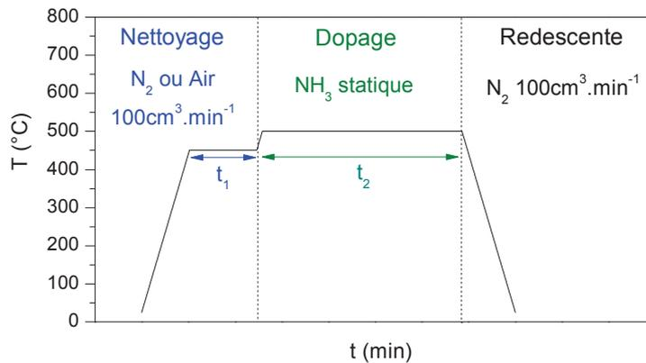
Figure III.7 : Schéma du traitement thermique appliqué lors du dopage à l'azote, avec  $t_1=4h$  et  $t_2=6,12$  et 24h.
