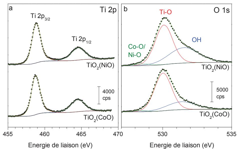
Figure A2 : Spectres XPS des régions (a) Ti 2p et (b) O 1s de nanotubes de TiO<sub>2</sub> décorés avec des nanoparticules de CoO ou NiO ( $N_{LP}=10000$ )
