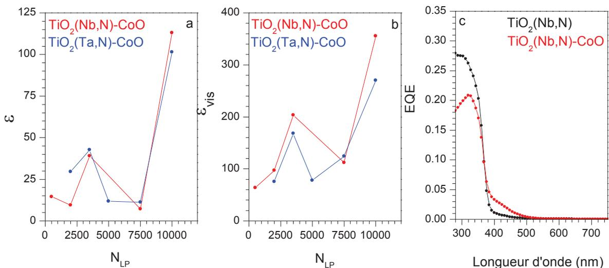
**Figure IV.27 :** Evolution de (a)  $\varepsilon$  et (b)  $\varepsilon_{\text{vis}}$  en fonction de  $N_{\text{LP}}$  pour les nanotubes co-alliés  $\text{TiO}_2(\text{Nb,N})$  et  $\text{TiO}_2(\text{Ta,N})$  avec dépôt de CoO. (c) EQE d'un échantillon co-allié  $\text{TiO}_2(\text{Nb,N})$  avant et après dépôt de CoO ( $N_{\text{LP}}=10000$ )
