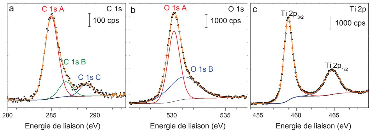
Figure II.14 : Spectre XPS des régions (a) C 1s, (b) O 1s et (c) Ti 2p d'un échantillon de nanotubes de TiO<sub>2</sub> calciné à 500°C
