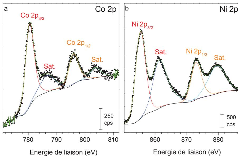
Figure A1 : Spectre XPS de la région (a) Co 2p d'un échantillon TiO<sub>2</sub>-CoO( $N_{LP}=10,000$ ) et (b) Ni 2p d'un échantillon TiO<sub>2</sub>-CoO ( $N_{LP}=10,000$ )
