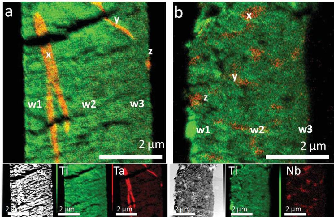
Figure III.5 : Cartographie MET-EDX de nanotubes de TiO<sub>2</sub> dopé (a) Ta et (b) Nb. Les grandes images sont une superposition des 3 images en bas de la figure, correspondant à un cliché en champ sombre, à la répartition du Ti et à la répartition du Ta/Nb.
