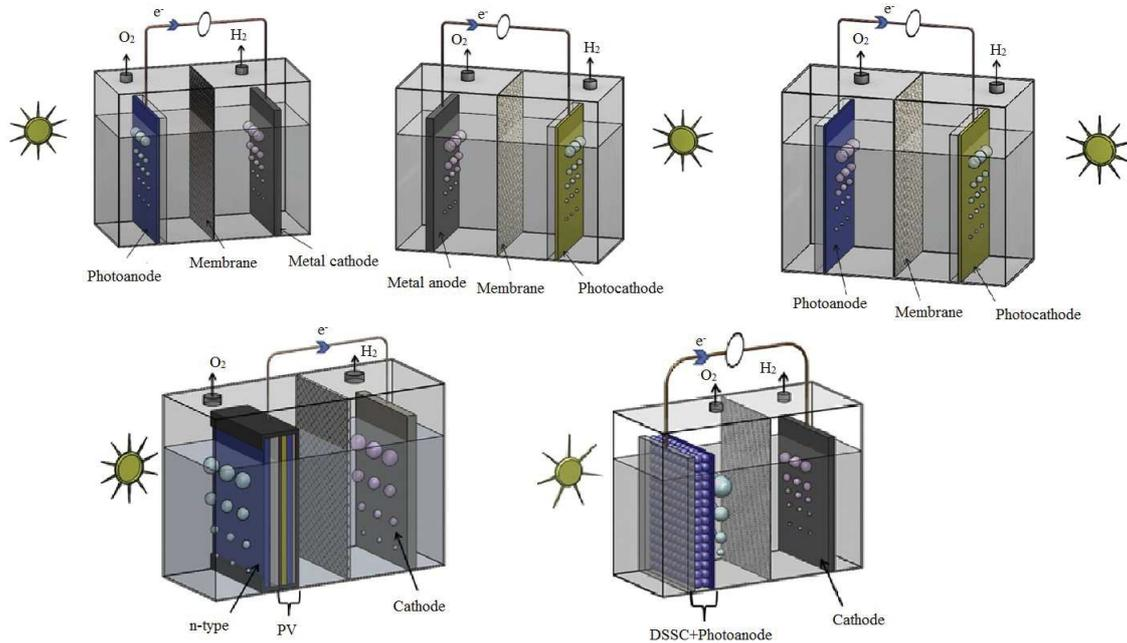
Figure I.12 : Schéma des différentes configurations de cellule photoélectrochimique[37]
