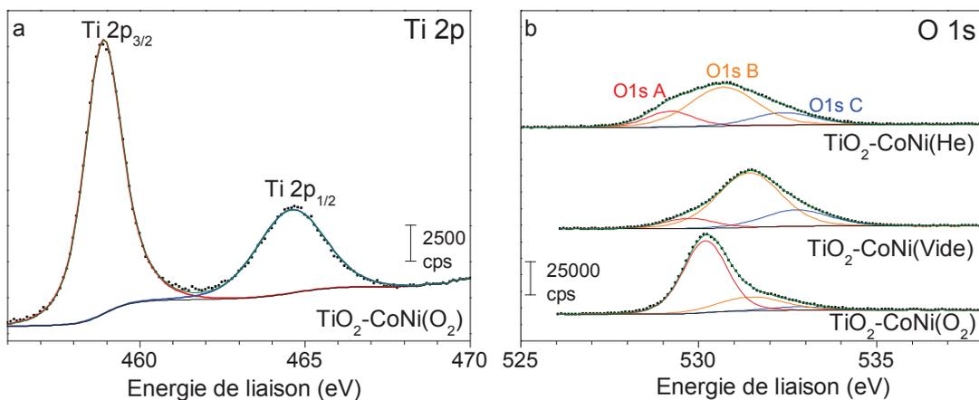
*Figure IV.9 : Spectre XPS des régions (a) Ti 2p et (b) O 1s des échantillons TiO<sub>2</sub>-CoNi (N<sub>LP</sub>=10,000) préparés sous les trois atmosphères en ablation laser pulsé*
