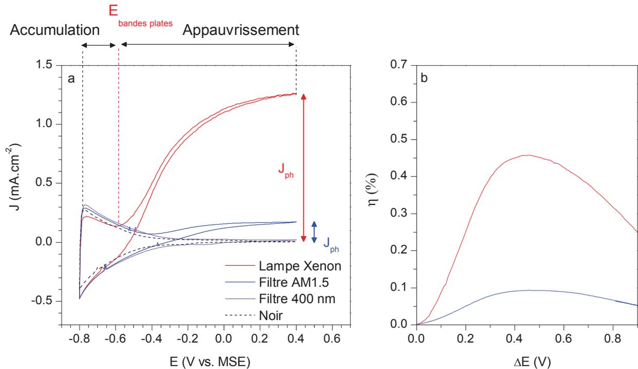
Figure II.22: (a) Voltammogramme typique d'un échantillon de nanotubes de  $\text{TiO}_2$  dans le noir (noir) et sous lumière Xénon (en rouge) ou avec le filtre AM1.5 (en bleu). Les traits pointillés rouge représentent le potentiel de bandes plates, et les flèches en haut de la figure représentent les différents régimes de la ZCE du  $\text{TiO}_2$  en fonction du potentiel appliqué. (b) Rendement photoélectrochimique correspondant.
