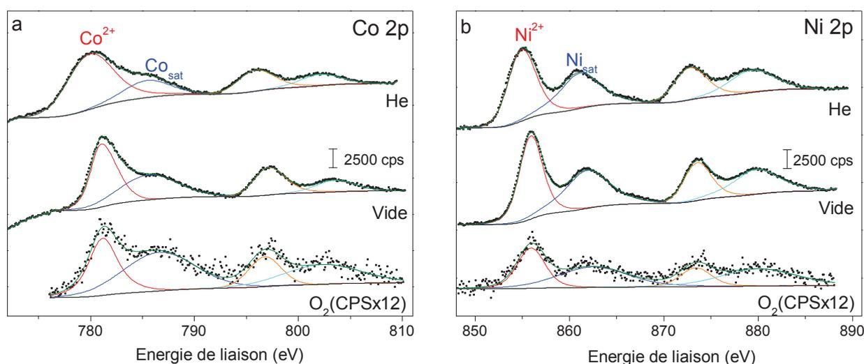
*Figure IV.10 : Spectres XPS des régions Co 2p et (b) Ni 2p des nanotubes de TiO<sub>2</sub> décorés avec NPs de CoNi sous les trois atmosphères étudiées*
