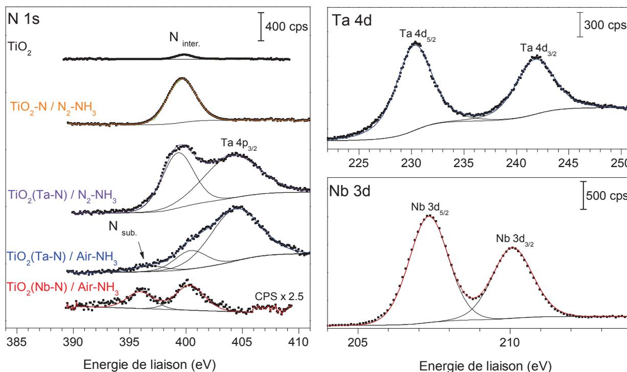
Figure III.11 : Spectres XPS des régions N 1s des nanotubes de  $\text{TiO}_2$  non dopé, dopé N et co-allié (Nb,N) et (Ta,N). Les régions Ta 4d et Nb 3d correspondent aux échantillons co-alliés.
