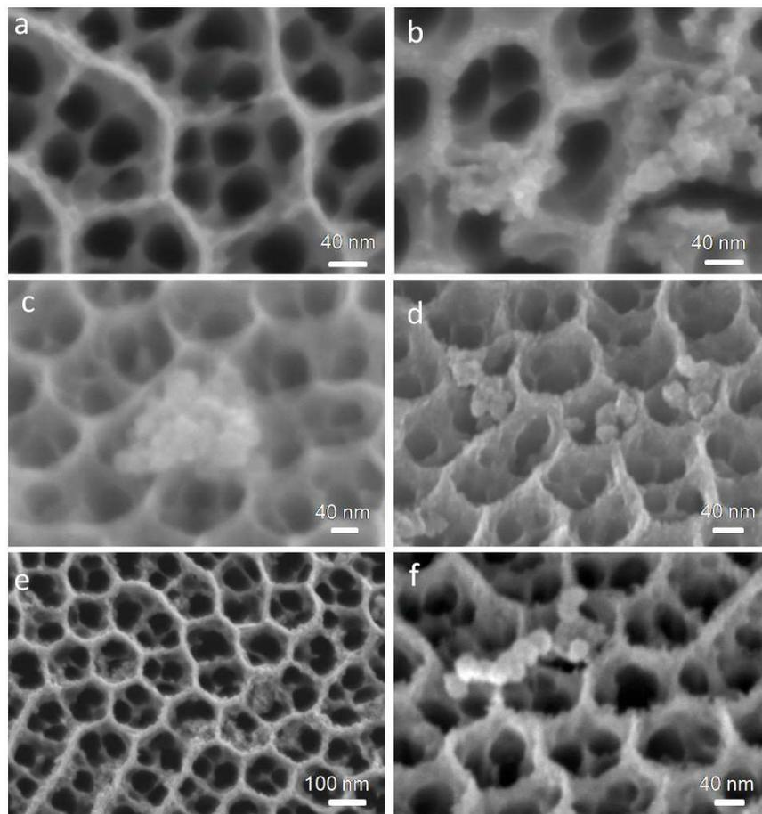
Figure IV.6 : Clichés MEB du sommet de nanotubes (a) avant décoration et après décoration avec la cible CoNi sous (b) oxygène ( $N_{LP}=500$ ), (c) vide ( $N_{LP}=500$ ) et (d) hélium ( $N_{LP}=500$ ). Sommet des nanotubes après décorations avec (e) la cible Co ( $N_{LP}=10,000$ ) et (f) Ni ( $N_{LP}=2000$ )
