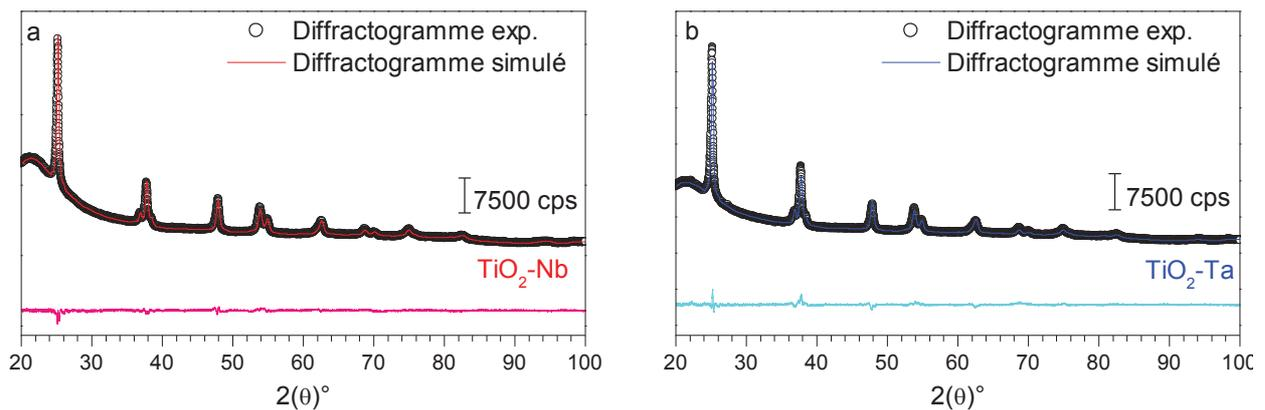
*Figure III.4 : Diffractogrammes expérimental et simulé par méthode Rietveld de nanotubes de  $\text{TiO}_2$  dopé (a) Nb et (b) Ta. La différence entre la courbe expérimentale et simulée est représentée en (a) rose et (b) cyan sous le diffractogramme.*
