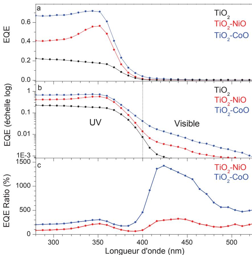
Figure IV.20 : Courbes d'EQE des nanotubes de  $\text{TiO}_2$  avant et après décoration avec des nanoparticules de  $\text{CoO}$  et  $\text{NiO}$  en (a) échelle linéaire, (b) échelle logarithmique et (c) ratio d'EQE décrit selon l'équation IV.18
