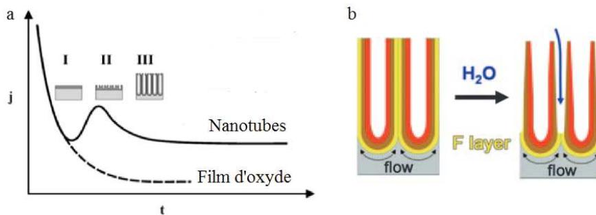
*Figure II.5 : (a) Courbe typique de la densité de courant en fonction du temps lors de l'anodisation d'une feuille de titane sans fluorures (film d'oxyde) et avec fluorures (nanotubes)[4] et (b) mécanisme de formation des nanotubes*
