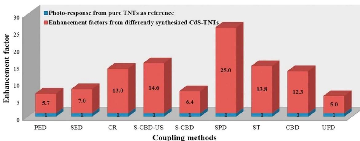
*Figure I.28 : Amélioration de l'activité PEC de nanotubes de  $\text{TiO}_2$  couplés avec du CdS selon différentes méthodes de synthèse[115]. PED : Plain Electrochemical Deposition; SED : Sonoelectrochemical deposition; CR : Cathodic Reduction; S-CBD-US : Ultrasonication assisted sequential Chemical Bath Deposition; S-CBD : Sequential Chemical Bath Deposition; SPD : Spray Pyrolysis Deposition; ST : Solvothermal Method; CBD : Chemical Bath Deposition et UPD : Under Potential Deposition*
