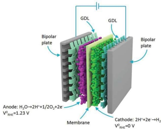
Figure I.9 : Schéma de fonctionnement d'un électrolyseur PEM[26]
