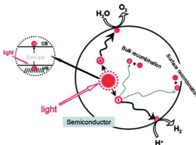
Figure I.10 : Schéma du fonctionnement de la photocatalyse [32]
