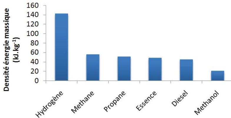
Figure I.6 : Densité énergétique massique de plusieurs carburants usuels[10]
