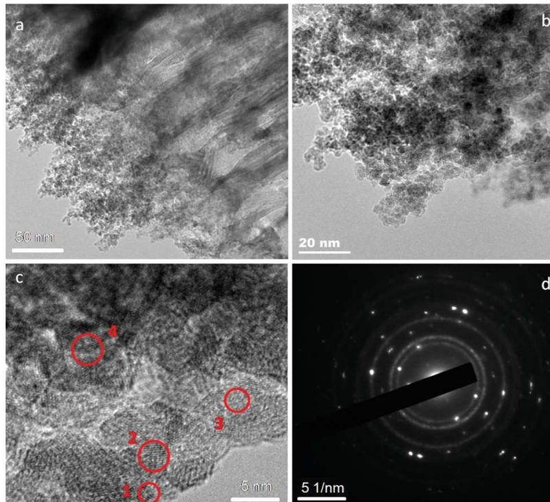
*Figure IV.8 : (a,b,c) Photos TEM de NTs de TiO<sub>2</sub> décorés avec des NPs de CoNi (300 mtorr O<sub>2</sub>; N<sub>LP</sub>=20,000) et (d) cliché de diffraction effectué sur la zone de la photo c*
