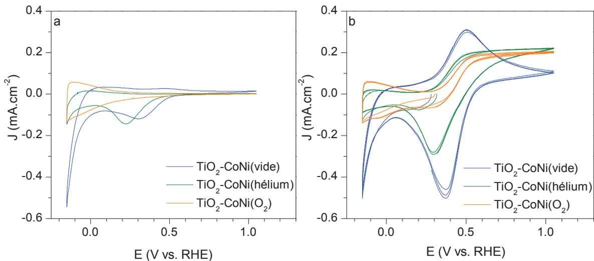
Figure IV.15 : Voltammogrammes (a) dans le noir et (b) sous lumière avec le filtre AM1.5 (100 mW.cm<sup>-2</sup>) des nanotubes de TiO<sub>2</sub> décorés avec nanoparticules de CoNi, préparées sous vide, hélium et oxygène ( $N_{LP}=10,000$ )
