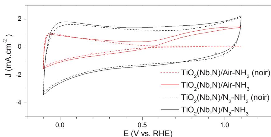
Figure III.14 : Voltammogrammes de nanotubes co-alliés TiO<sub>2</sub>(Nb,N) ayant subi une étape de nettoyage thermique sous air et sous N<sub>2</sub>.
