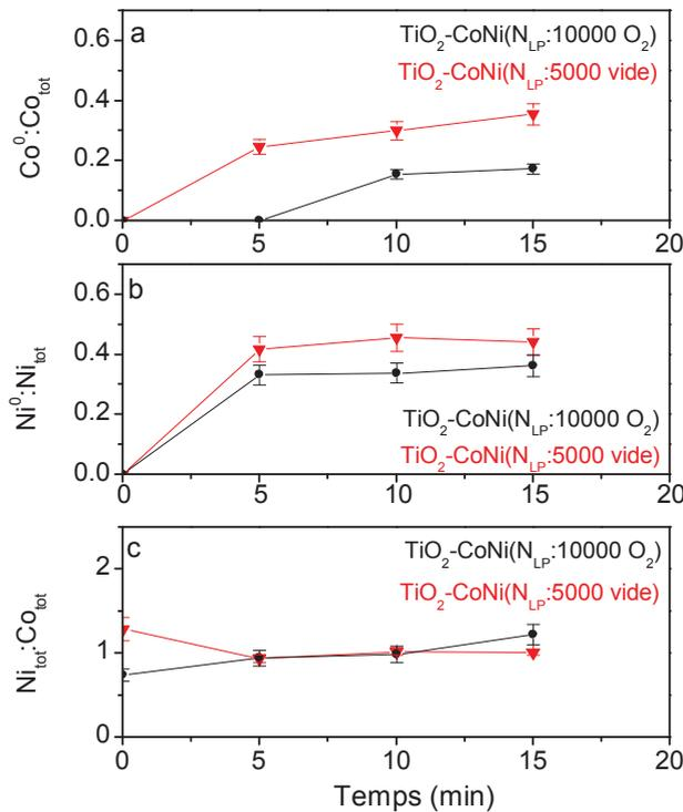
Figure IV.13 : Ratio de la quantité de (a) cobalt et de (b) nickel métallique par rapport à la quantité de cobalt totale et de nickel totale, et (c) quantité de nickel totale par rapport au cobalt total, en fonction du temps de décapage ionique.
