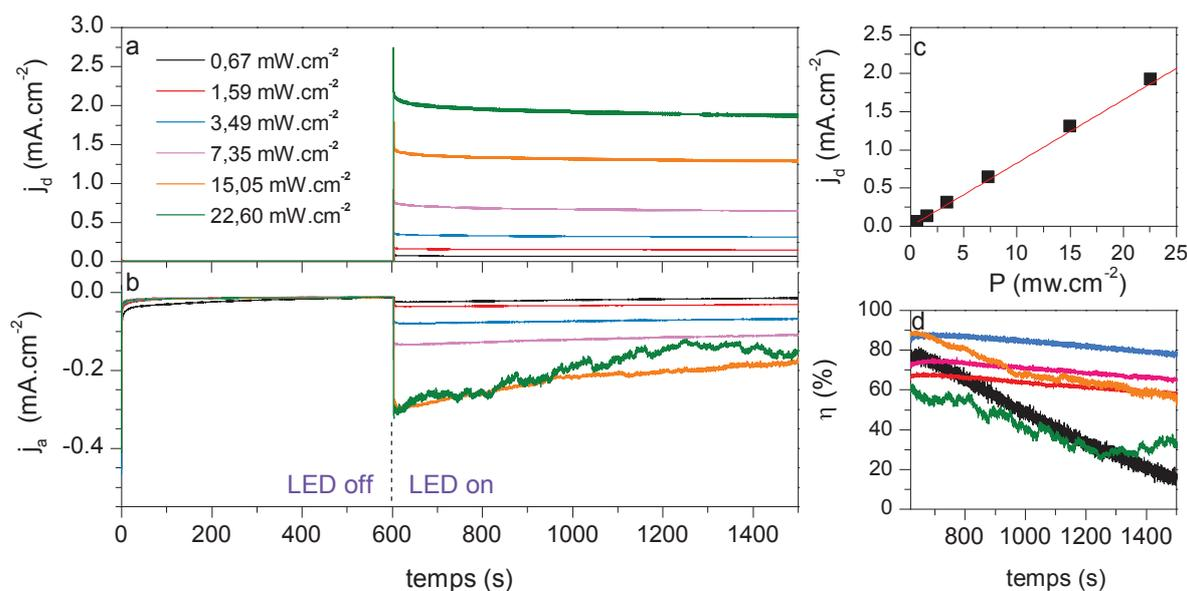
*Figure A17 : Densités de courants enregistrées en chronoampérométrie sur le disque de NTs de  $\text{TiO}_2$  ( $E=0,948$  V vs. RHE) et sur l'anneau de Pt ( $E=0,348$  V vs. RHE) sous différentes densités de puissances de LED365nm. (c) Densités de photocourants du disque de NTs de  $\text{TiO}_2$  en fonction de la densité de puissance de la LED365nm et (d) rendements faradiques de l'oxygène en fonction du temps.*
