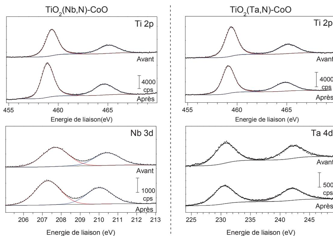
Figure A6 : Spectres XPS des régions  $\text{Ti } 2p$ ,  $\text{Nb } 3d$  et  $\text{Ta } 4d$  avant et après tests PEC des échantillons co-alliés avec dépôt de CoO ( $N_{LP}=10000$ )
