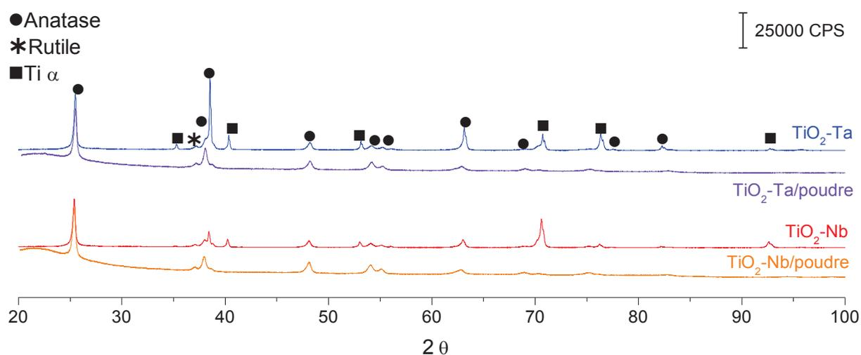
*Figure III.3 : Diffractogrammes des nanotubes dopés Nb et Ta avant et après détachement de leur support. Les échantillons dénommés /poudre correspondent aux nanotubes détachés, qui ont subi un broyage au mortier avant analyses DRX*
