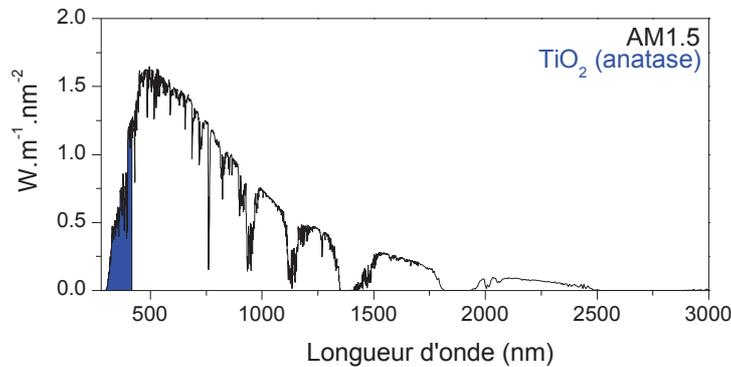
Figure I.22 : Domaine d'absorption du TiO<sub>2</sub> (anatase) par rapport au spectre AM 1.5
