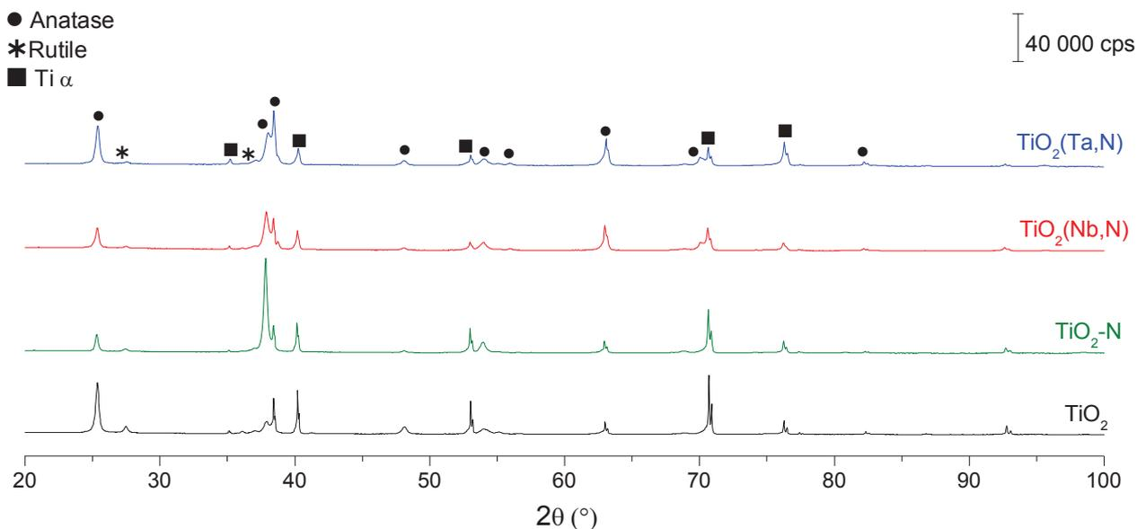
Figure III.12 : Diffractogrammes des échantillons non dopés, dopés N et co-alliés. Les nanotubes de TiO<sub>2</sub> sont calcinés à 500°C sous air pendant 12h, et les nanotubes dopés N et co-alliés sont traité thermiquement avec une étape de nettoyage à 450°C (4h, 100cc air) suivie d'une étape de dopage à 500°C (NH<sub>3</sub> statique, 12h).
