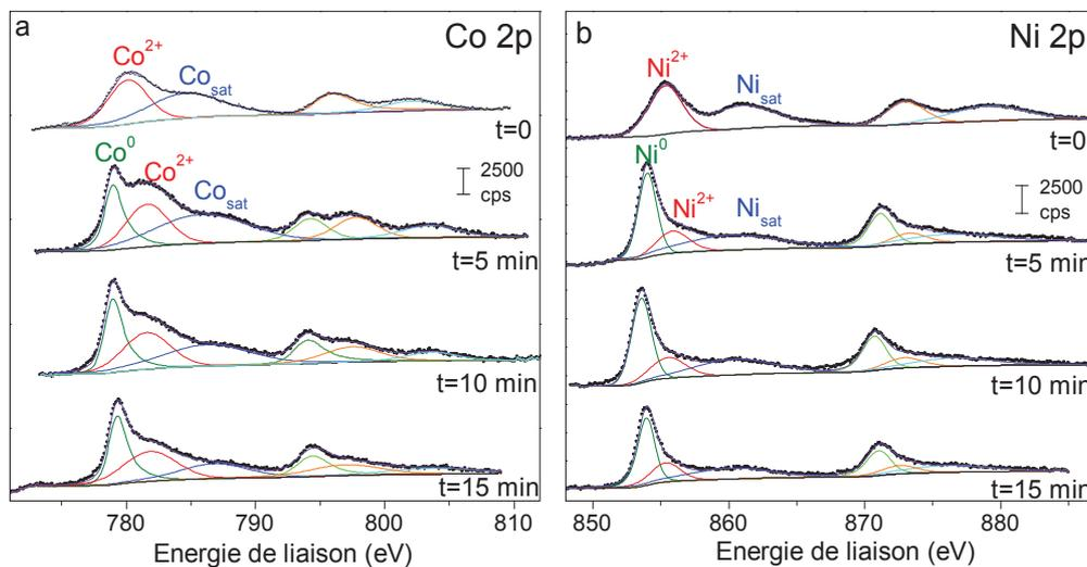
**Figure IV.11** : Spectre XPS des régions (a) Co 2p et (b) Ni 2p d'un échantillon de nanotubes de  $\text{TiO}_2$  avec dépôt de CoNi effectué sous vide. Le temps indique les différentes étapes de décapage aux ions  $\text{Ar}^+$
