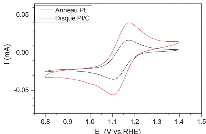
Figure A11 : Voltammogrammes de l'anneau et du disque réalisé sans rotation de l'électrode tournante, dans un électrolyte désaéré (0,01M NaOH + 0,1M Na<sub>2</sub>SO<sub>4</sub> + 5mM K<sub>3</sub>Fe(CN)<sub>6</sub>)
