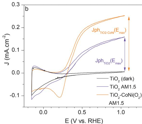
Figure IV.17 : Voltamogrammes avant et après dépôt sous oxygène de CoNi ( $N_{LP}=500$ )
