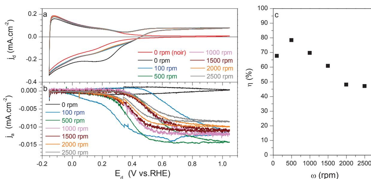
Figure A16 : (a) Voltamogrammes du disque de NTs de TiO<sub>2</sub> à différentes vitesses de rotation sous illumination (LED365nm ; 0,67 mW.cm<sup>-2</sup>) avec (b) les courants de réduction correspondant enregistré sur l'anneau. (c) Rendement faradique de la production d'oxygène en fonction de la vitesse de rotation de l'électrode tournante.
