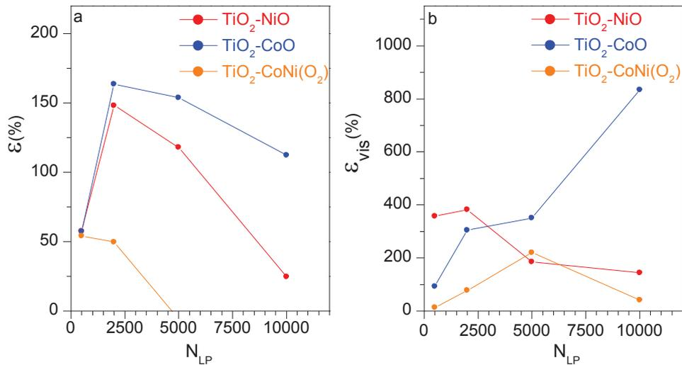
Figure IV.19 : Variation de (a)  $\epsilon$  et (b)  $\epsilon_{vis}$  en fonction de  $N_{LP}$  pour les échantillons  $TiO_2-NiO$ ,  $TiO_2-CoO$  et  $TiO_2-CoNi$ .
