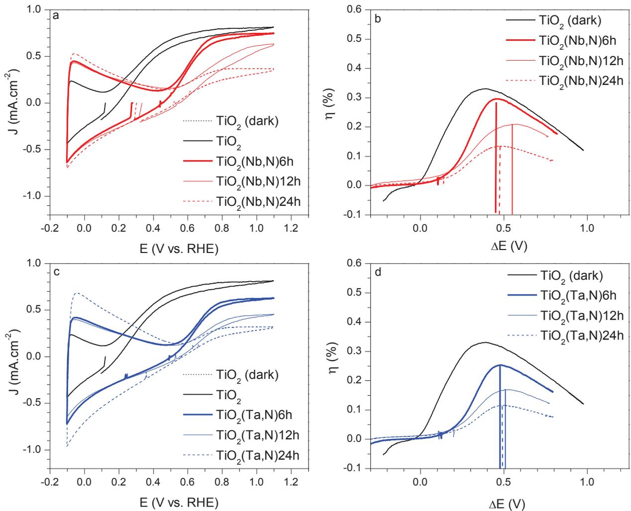
Figure III.16 : (a,c) Voltammogrammes des échantillons co-alliés ayant subi un traitement thermique sous NH<sub>3</sub> durant 6, 12 et 24h, et (b,d) courbes de rendements correspondantes.
