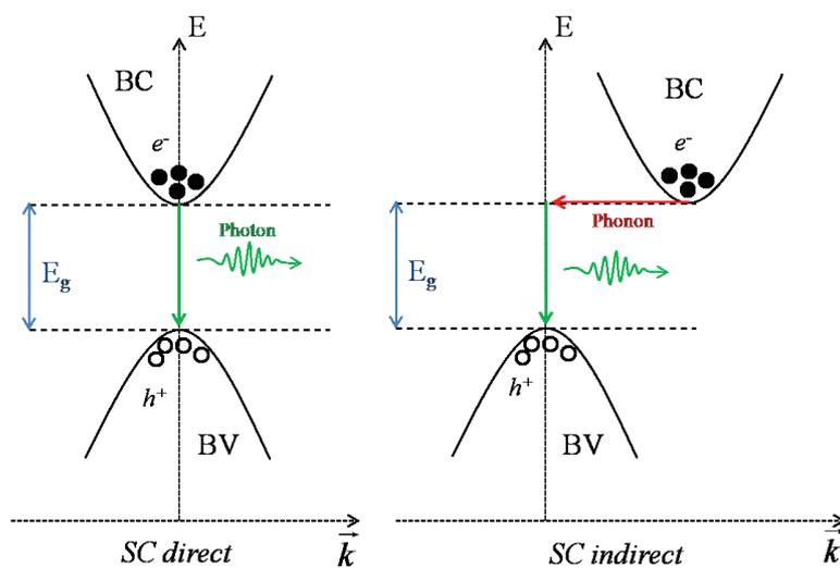
Figure I.14 : Schéma représentant un semi-conducteur direct et indirect
