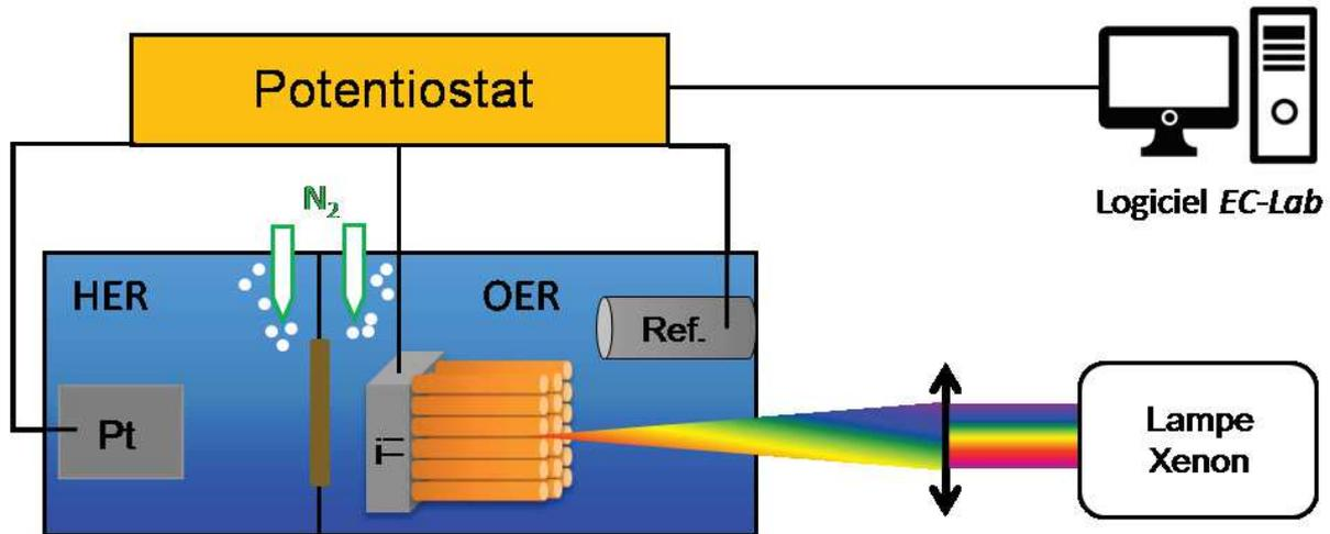
Figure II.16 : Schéma du montage expérimental de voltammétrie cyclique
