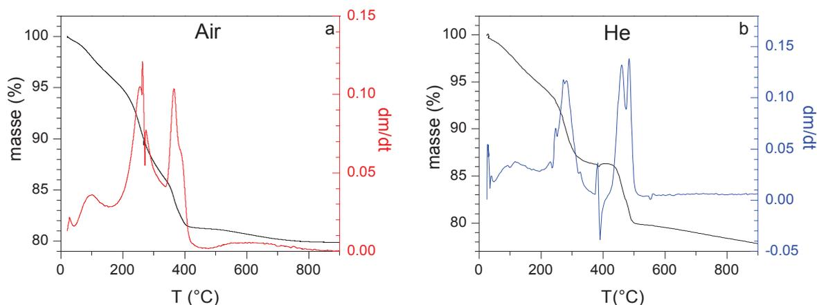
*Figure III.6 : Analyse thermogravimétrique de nanotubes de TiO<sub>2</sub> (a) sous air et (b) sous He*
