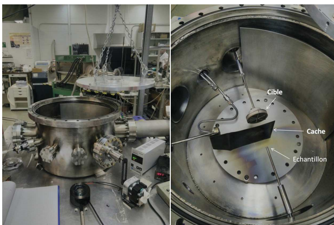
Figure IV.4: Enceinte d'ablation laser pulsée utilisée lors de dépôt de co-catalyseur sur nanotubes de \text{TiO}_2
