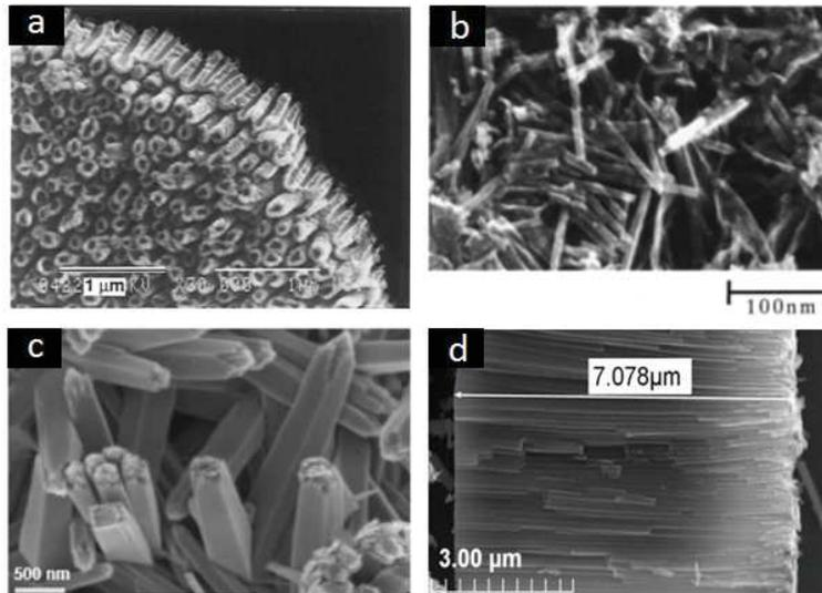
Figure II.1 : Nanotubes obtenus avec une synthèse par (a) template[1], (b) hydrothermale[2], (c) solvothermale (thèse Urelle Biapo) et (d) anodisation[13]
