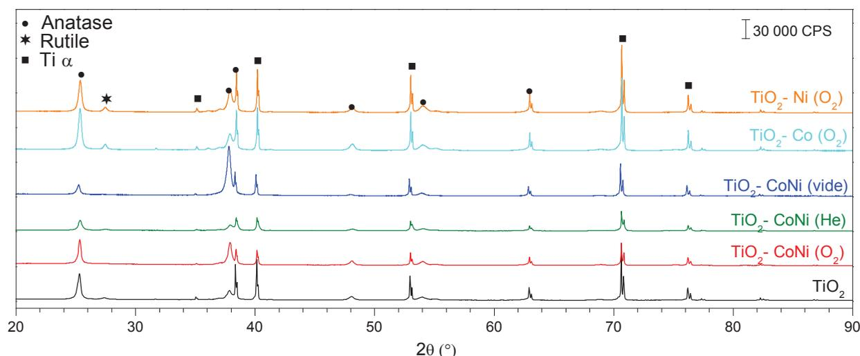
Figure IV.5 : Diffractogrammes des nanotubes de  $\text{TiO}_2$  avec dépôts de CoNi effectués sous vide, hélium et oxygène
