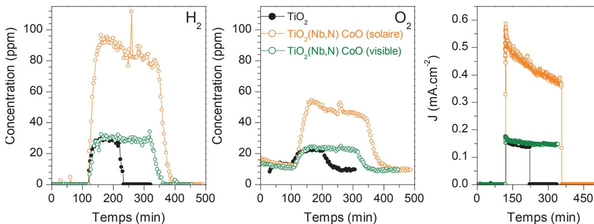
Figure IV. 33 : Productions (a) d'hydrogène, (b) d'oxygène et (c) photocourant obtenu en chronoamperométrie d'un échantillon de  $\text{TiO}_2(\text{Nb,N})\text{-CoO}$  ( $N_{LP}=10000$ )
