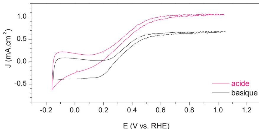
Figure II.23 : Voltammogrammes de nanotubes de  $\text{TiO}_2$  en électrolyte acide et basique
