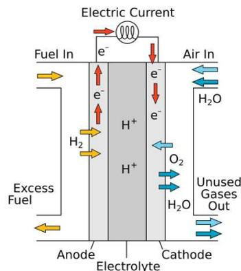
Figure I.7 : Schéma de fonctionnement d'une pile à combustible
