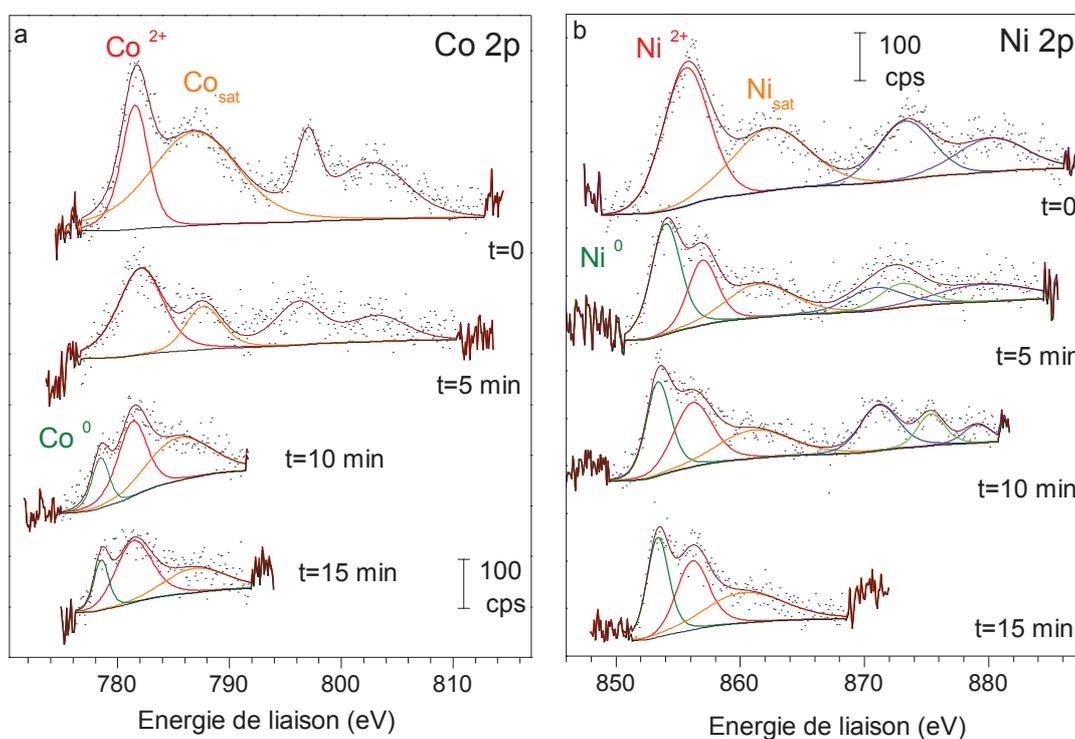
Figure A3 : Spectres XPS des régions (a)  $\text{Co 2p}$  et (b)  $\text{Ni 2p}$  de nanotubes de  $\text{TiO}_2$  décorés avec des nanoparticules de  $\text{CoNi}$  préparés sous 300 mtorr d' $\text{O}_2$ , après les différentes étapes d'attaque aux ions  $\text{Ar}^+$
