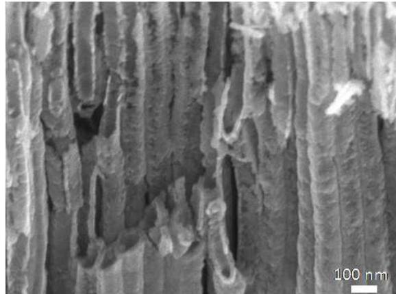
Figure II.7: Image MEB de nanotubes calcinés avec une rampe de 200°C.min<sup>-1</sup> à 500°C
