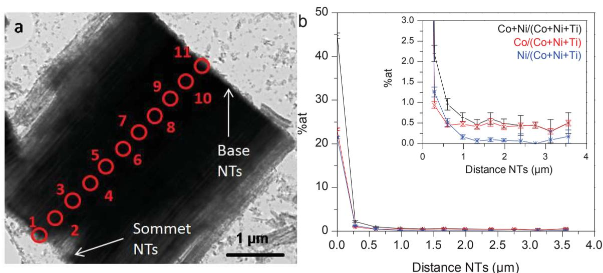
*Figure IV.7: (a) Photo TEM d'une portion complète de NTs de TiO<sub>2</sub> décorés avec des NPs de CoNi (300 mtorr O<sub>2</sub>;  $N_{LP}=20,000$ ). Les cercles rouges représentent les zones analysées par EDX. (b) Proportion de cations Co et Ni par rapport à la quantité de cations totale déterminée par EDX, en fonction de leur position dans les nanotubes (0 μm étant le sommet des NTs)*
