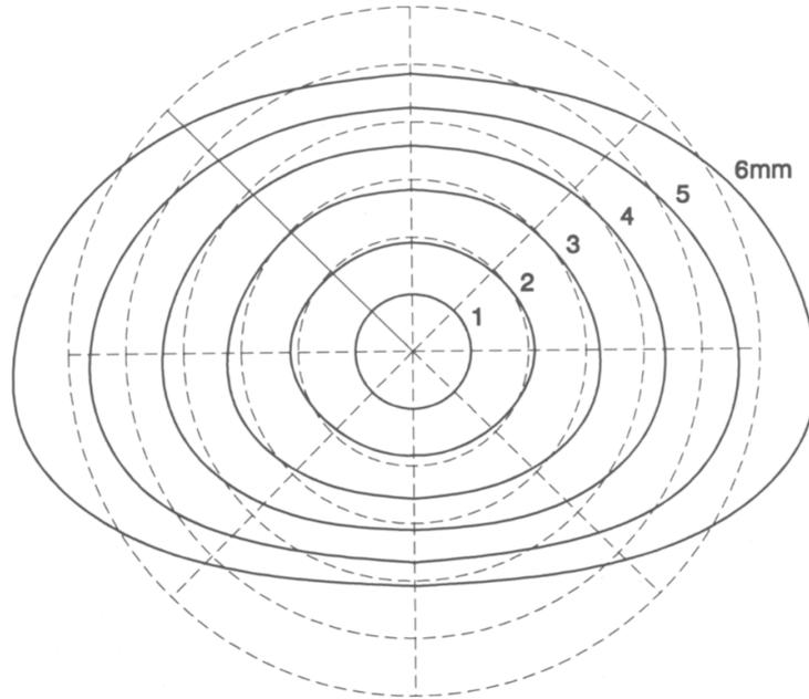
**Figure 36 : Formes des gouttes de pluie à l'équilibre pour des diamètres de 1 à 6 mm, d'après Beard and Chuang (1987).**
