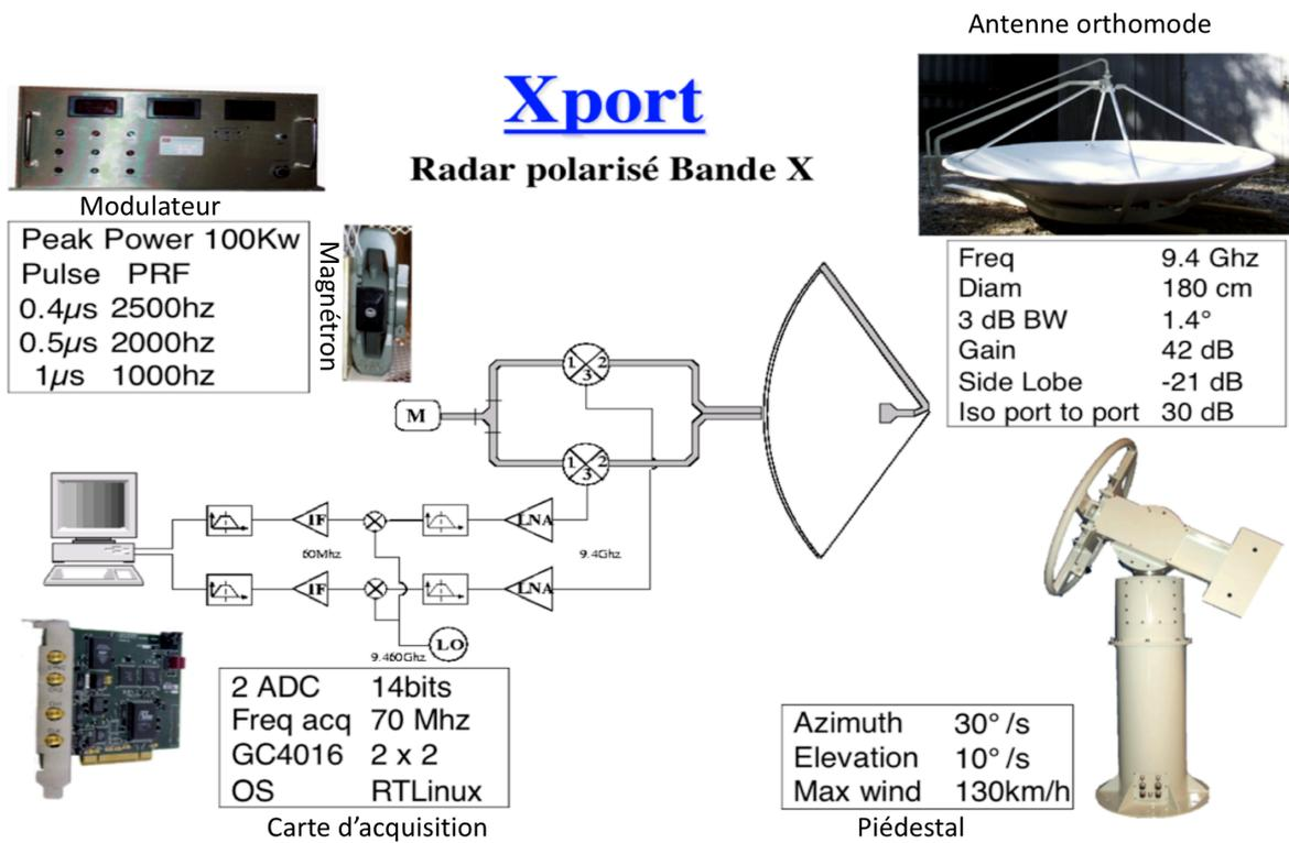
**Figure 8 : Schéma de principe de la chaîne d'émission et de réception du radar Xport et principaux éléments constituant le radar ( modulateur et magnétron en haut à gauche ; antenne équipée de son cornet orthomode en haute à droite ; piédestal en bas à droite ; carte d'acquisition en bas à gauche) avec leurs spécifications techniques.**
