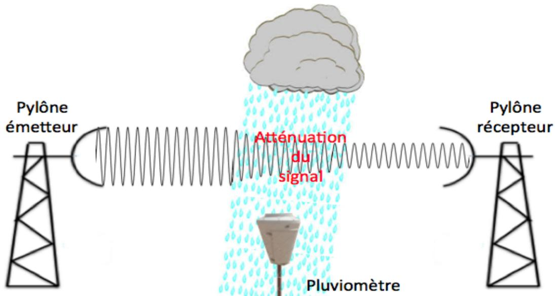
Figure 14 : illustration de l'atténuation pour la pluie d'une onde électromagnétique se propageant entre deux antennes d'un réseau de téléphonie mobile.
