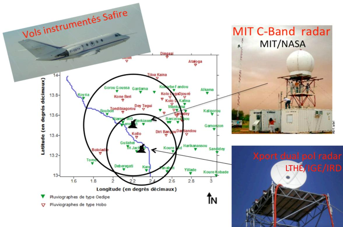
**Figure 9 : Dispositif expérimental de la pré-campagne Mégha-Tropiques au Niger en 2010 : le réseau de pluviographes AMMA-CATCH (58 stations), le radar bande C doppler du MIT, le radar polarimétrique XPORT et le Falcon 20 instrumenté de l'Unité de Service SAFIRE**
