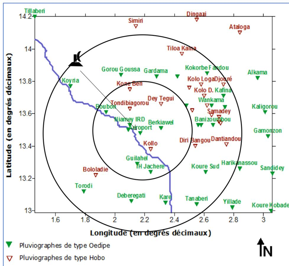
Figure 39 : Distribution des pluviographes sur le site du Niger et implantation du RADAR météorologique en 2006 et 2007. Les centrales d'acquisition Oedipe datent du début des années 1990 et ont été remplacées progressivement par des centrales de nouvelle génération Hobo à partir des années 2000. Les cercles marquent les distances au radar respectivement à 60 et 120km.
