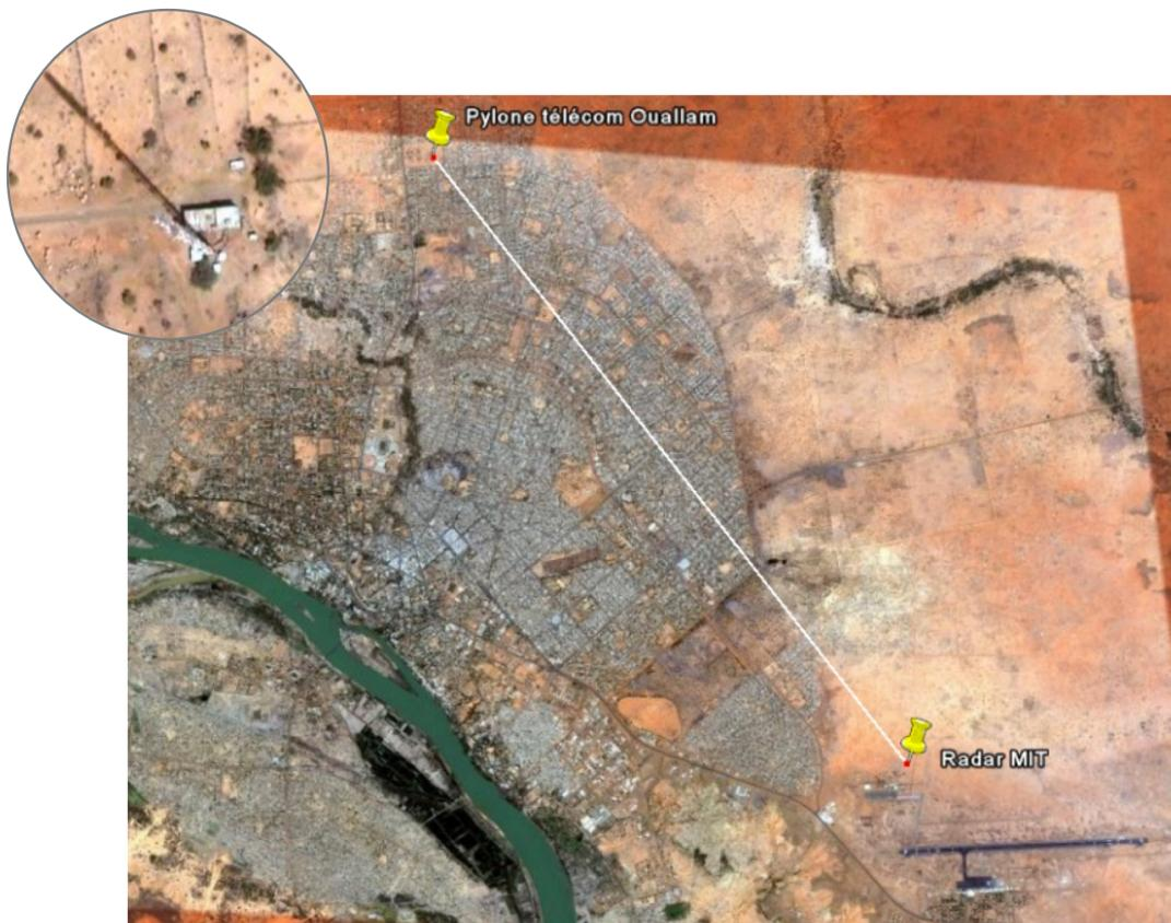
**Figure 48 : Image satellite (source Google Earth) de Niamey avec les marqueurs de position du radar ( $13^{\circ}29'29.57''N$ ,  $2^{\circ}10'11.33''E$ ) et du pylône de télécommunication ( $13^{\circ}33'35''N$ ,  $2^{\circ}6'52''E$ ). Le trait blanc représente la radiale radar d'azimut  $322^{\circ}$  comprenant la réflectivité rétrodiffusée par la structure métallique. Sur l'image grossie, en haut à gauche, est visible le pylône blanc et son ombre projetée au sol.**
