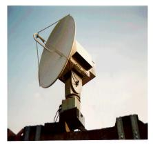
Figure 4: XNT, radar bande X du LTHE fabriqué par Gematronik ayant en de 1996 à 1998.
