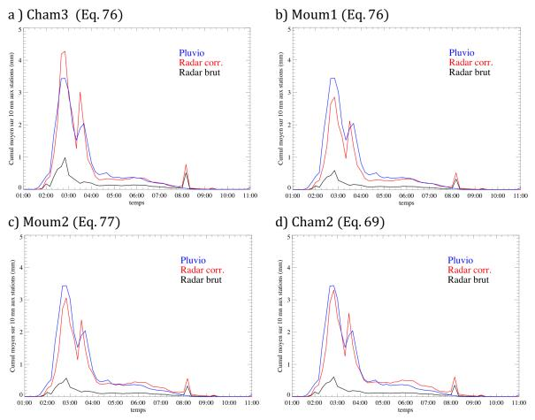
Figure 59: Tracés des hyétogrammes moyens aux stations, observés et estimés à l'aide de différentes relation ZR proposées dans la littérature pour les lignes de grain ou de type convective en Afrique de l'ouest, appliquées à l'évènement du 24 septembre 2006.
