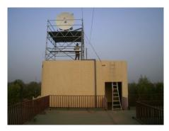
Figure 11 : le radar Xport installé sur le toit d'un bâtiment de la Direction de la Météorologie du Burkina Faso lors des campagnes Mégha-Tropiques 2012-2014.
