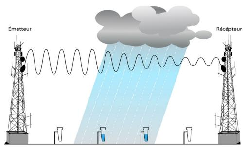
Figure 73 : Schéma de principe de l'atténuation par la pluie d'une onde électromagnétique transmise d'un pylône émetteur à un pylône récepteur.
