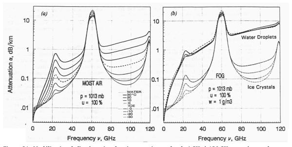
Figure 81 : Modélisation de l'atténuation des signaux microondes de 1 GHz à 120 GHz en présence de vapeur d'eau (a) et sous brouillard ( $w=1g.m^{-3}$ ) (b) pour différentes températures pour une pression atmosphérique de 1013 mbar et une humidité relative de 100% (d'après Liebe 1993)
