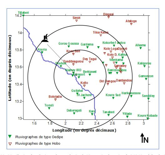
Figure 39 : Distribution des pluviographes sur le site du Niger et implantation du RADAR météorologique en 2006 et 2007. Les centrales d'acquisition Œdipe datent du début des années 1990 et ont été remplacées progressivement par des centrales de nouvelle génération Hobo à partir des années 2000. Les cercles marquent les distances au radar respectivement à 60 et 120km.
