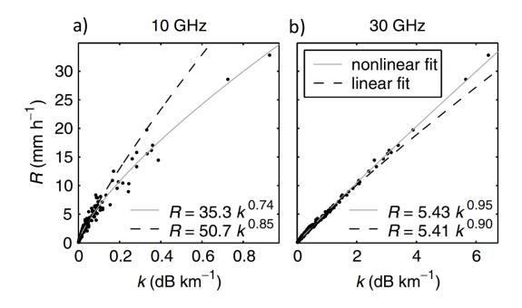
Figure 76 : Résultats des ajustements des relations de puissance k-R aux fréquences de 10 GHz (a) et 30 GHz (b). Les ajustements polynomiaux sont représentés par les lignes grises continues et les ajustements linéaires des logarithmes par les lignes noires pointillées. (d'après Leijnse et al. 2008)
