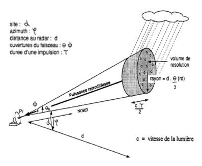
Figure 33 : Schéma présentant les principales caractéristiques d'un volume élémentaire radar situé à une distance d, à l'azimute  $\varphi$  et au site  $\alpha$ . Son rayon est fonction des angles d'ouverture de l'antenne,  $\theta$  et  $\varphi$ , et sa profondeur dépend de la durée  $\tau$  de l'impulsion électromagnétique (d'après Faure, 1993).
