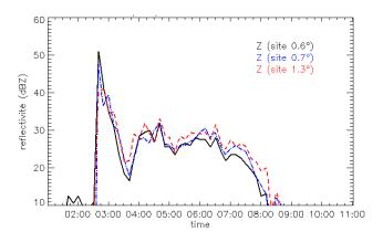
Figure 61: Réflectivités mesurées au cours de l'événement du 24/09/2006 à l'aplomb de la station de Banizoumbou aux 3 sites bas  $(0.6, 0.7 \text{ et } 1.3^{\circ})$ .
