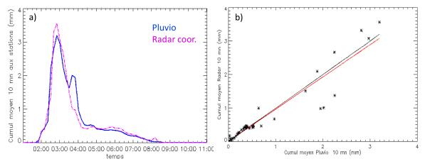
Figure 64: Hyétogrammes moyens estimés à partir des données radar et mesurés pour l'évènement précipitant du 24 septembre 2006 (a) après intégration radiale sur 1km et verticale sur 3 sites bas. Le diagramme de dispersion des cumuls moyens aux stations au regard des estimations radar (b) présente une corrélation (R²) de 0.911 et une efficience de Nash de 0.907 pour un étalonnage de 2.7 dB.
