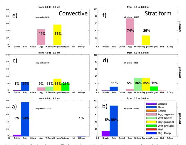
Figure 91 : Distributions des types d'hydrométéores, indiquées en pourcentage, pour la couche de précipitation liquide comprise entre 0 à  $3 \, \text{km}$  (a ; b), la couche de fusion de  $4 \, \text{à} \, 5 \, \text{km}$  (c ; d) et la couche de précipitation solide de  $6 \, \text{à} \, 8 \, \text{km}$  (e ; f) pour les parties convectives et stratiformes de l'événement du  $13 \, \text{août} \, 2010$  (d'après <u>Cazenave et al. 2016</u>).
