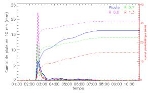
Figure 62: Hyétogrammes et cumuls mesurés et estimés aux sites d'élévation d'antenne 0.6, 0.7 et 1.3° à la verticale de la station de Banizoumbou le 24/09/2006.
