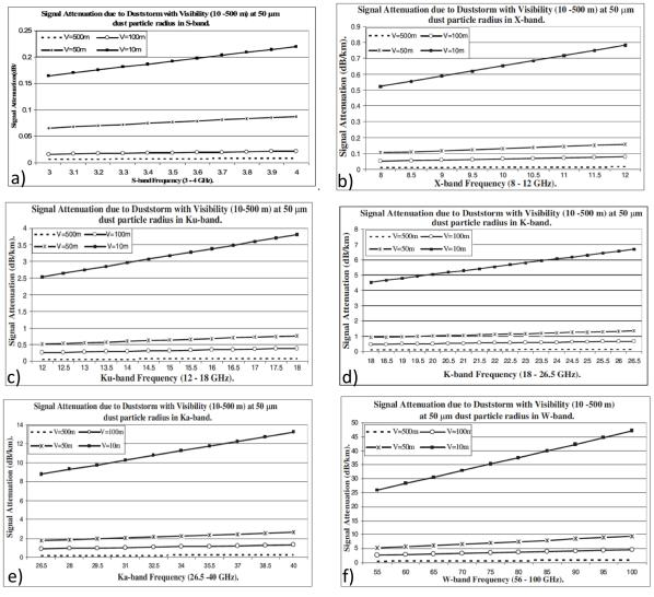
Figure 82: Modélisation de l'atténuation par la présence de particule de sable sur le trajet d'une onde électromagnétique en fonction de la visibilité (10, 50, 100, 500m) pour différentes gammes de fréquences de 3 GHz à 4 GHz (a), de 8 GHz à 12 GHz (b), de 12 GHz à 18 GHz (c), de 18 GHz à 16,5 GHz (d) ), de 26,5 GHz à 40 GHz (e) de 56 GHz à 100GHz (f), (extrait de Islam et al. 2010)
