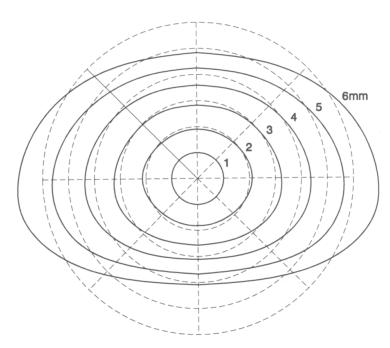
Figure 36 : Formes des gouttes de pluie à l'équilibre pour des diamètres de 1 à 6 mm, d'après Beard and Chuang (1987).
