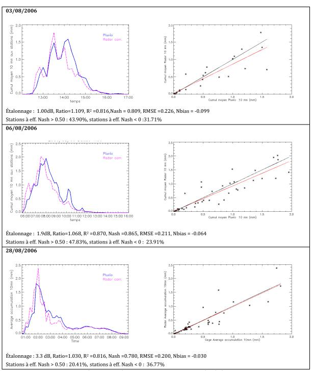
Figure 66 : Application de la méthode d'intégration radiale et multi-sites à 7 événements de la saison des pluies 2006 sur le Degré carré de Niamey : hyétogrammes moyens estimés et observés (colonne de gauche) ; diagrammes de dispersion des couples  $\left(\sum \frac{R_g}{n}, \sum \frac{R_e}{n}\right)$  pour chacune des stations pluviographiques. L'étalonnage est précisé pour chacun des évènements ainsi que les principaux scores statistiques obtenues.
