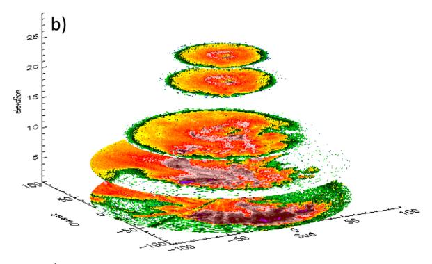
Figure 43 : Évolution de l'élévation de l'antenne du radar au cours d'un cycle d'exploration volumique (a). Représentation volumique de l'atmosphère proche du radar (+/- 100km) pour 5 angles de site lors de l'événement pluvieux du 17 juillet 2006 à 00 :19 UTC (b).
