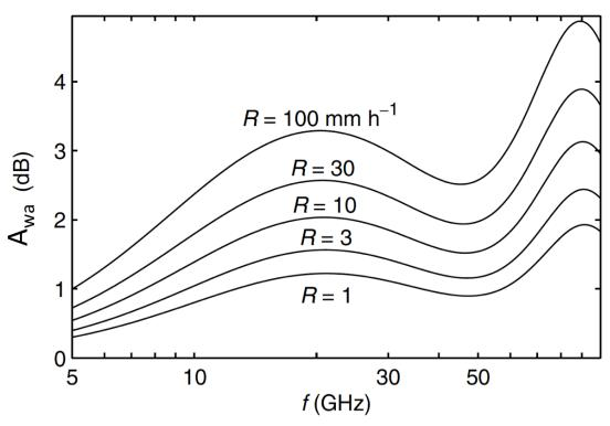
Figure 79 : Atténuation induite par les précipitations sur une antenne de télécommunication, pour différentes intensités de pluie, en fonction de la fréquence de l'onde électromagnétique (d'apés Leijnse et al. 2008)
