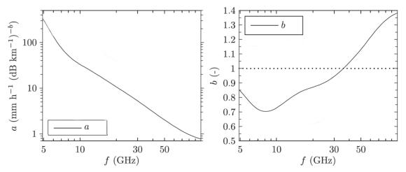
Figure 75 : Sensibilité du coefficient a (à droite) et de l'exposant b (à gauche) de la relation k-R en fonction de la fréquence mise en œuvre. (d'après Leijnse et al. 2010)
