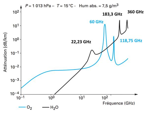
Figure 80 : Absorption des ondes électromagnétiques par l'oxygène (ligne bleue) et la vapeur d'eau (ligne noire) sur la gamme de fréquence de 1 à 1000 GHz (d'après Castanet and Lassudrie-Duchesne 2008)
