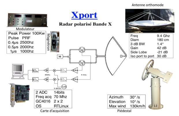
Figure 8 : Schéma de principe de la chaine d'émission et de réception du radar Xport et principaux éléments constituants le radar (modulateur et magnétron en haut à gauche ; antenne équipée de son cornet orthomode en haute à droite ; piédestal en bas à droite ; carte d'acquisition en bas à gauche) avec leurs spécifications techniques.
