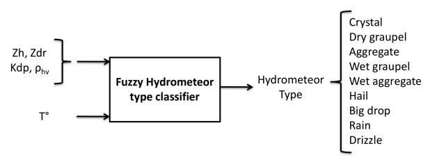
Figure 89 : Schéma de principe de l'algorithme HID
