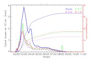
Figure 63 : Hyétogrammes moyens et cumuls moyens mesurés et estimés aux sites 0.6, 0.7 et  $1.3^{\circ}$  le 24/09/2006, aux stations pluviographiques.
