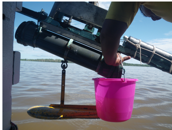
FIGURE 3.12. Récupération d'un échantillon du préleveur Callède en 2014.
