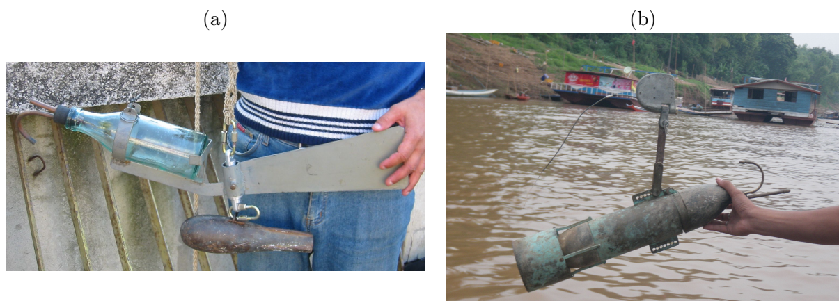
FIGURE 2.18. Préleveur ponctuel isocinétique «USSR series bottle sampler» (Starosolsky et Rakoczi, 1981) utilisé sur la rivière Timiș en Roumanie, en 2005 lors d'une campagne de mesures ADCP avec prélèvement (Dramais et al. , 2006; Rotaru et al. , 2006). La buse courbée est placée vers le haut lors du déploiement dans la rivière (a). La version suédoise du préleveur isocinétique intégratif appelé «Nilsson sampler» (Nilsson, 1969), déployé à Khong Chiam sur le Mekong en Thaïlande en 2012 (b).
