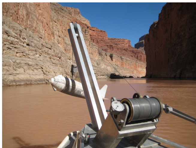
FIGURE 3.4. Dispositif de déploiement des préleveurs intégratifs sur le Colorado en 2019.
