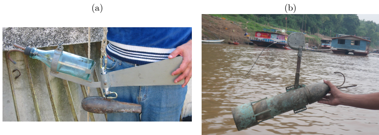
FIGURE 2.18. Préleveur ponctuel isocinétique «USSR series bottle sampler» (Starosolsky et Rakoczi, 1981) utilisé sur la rivière Timiș en Roumanie, en 2005 lors d'une campagne de mesures ADCP avec prélèvement (Dramais et al. , 2006; Rotaru et al. , 2006). La buse courbée est placée vers le haut lors du déploiement dans la rivière (a). La version suédoise du préleveur isocinétique intégratif appelé «Nilsson sampler» (Nilsson, 1969), déployé à Khong Chiam sur le Mekong en Thaïlande en 2012 (b).
