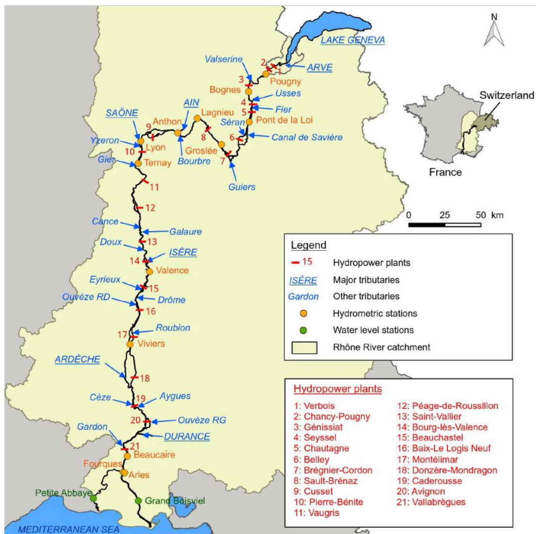
FIGURE 3.14. Le Rhône depuis le lac Lemman jusqu'à la mer, avec ses affluents, son réseau hydrométrique et hydroélectrique principal (Dugué et al. , 2015).
