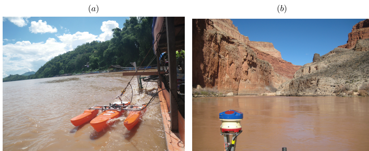
FIGURE 2.13. Exemples de déploiement ADCP : sur le Mekong en 2013 (Dramais et al. , 2015) (a) ; capteur ADCP sur sa potence en position de transport sur le Colorado au River Mile 31 en 2019 (b).
