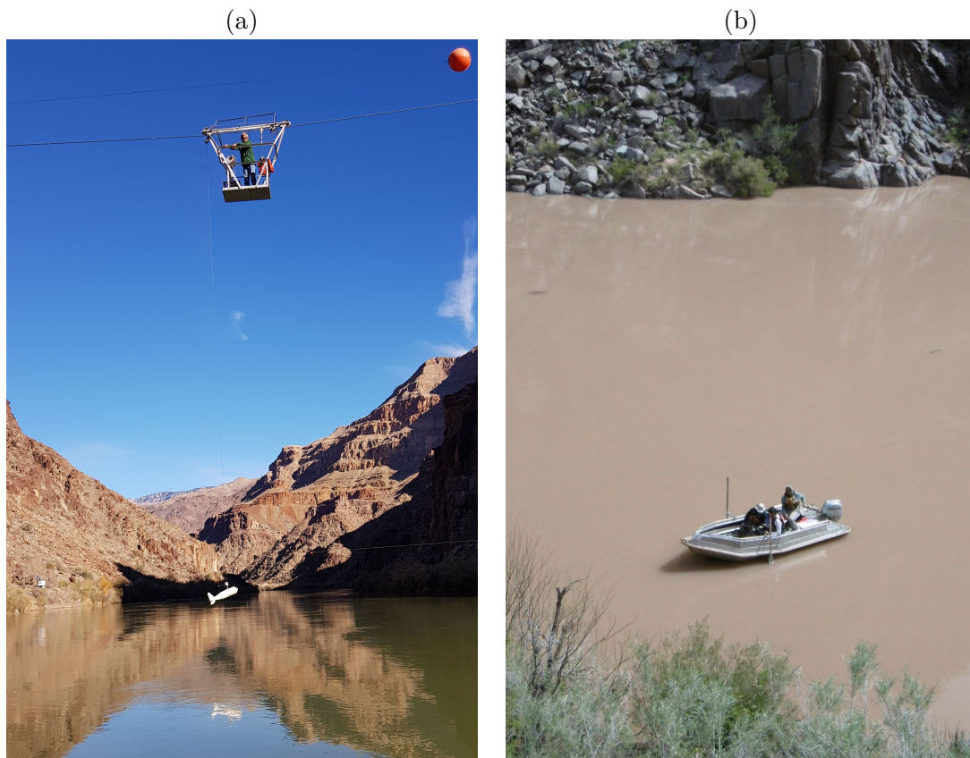
FIGURE 3.6. Déploiement d'un préleveur D-96 depuis la trille téléphérique de Diamond Creek sur le Colorado en décembre 2018 (a). Déploiement de la bouteille horizontale depuis une barque de mesure Diamond Creek sur le Colorado en avril 2019 (b).
