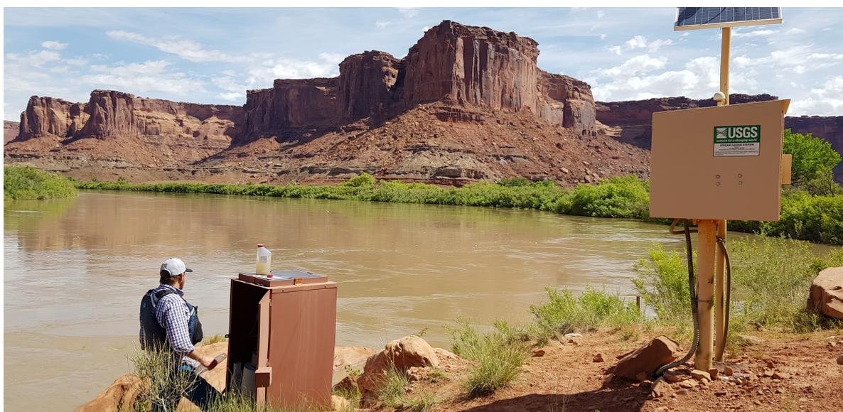
FIGURE 2.25. Station hydrosédimentaire typique avec armoire d'acquisition et préleveur automatique protégé dans une logette, ici sur la Green River à Canyonlands en Utah.
