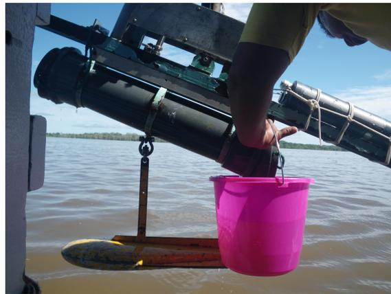
FIGURE 3.12. Récupération d'un échantillon du préleveur Callède en 2014.
