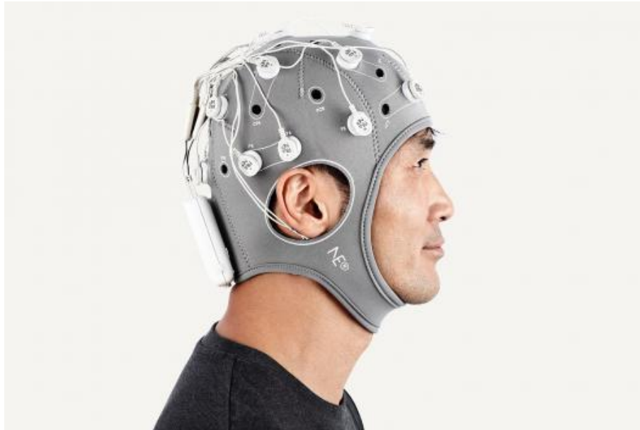
FIGURE 1.16 – Système d’acquisition Enobio®EEG (Neuroelectric®)
