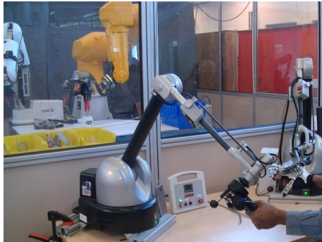
(a) Bras maître Virtuose TM 6D – Haption SA (b) Téléopération pour la médecine (source : (avant-plan) et bras esclave (arrière-plan) [Borden Jr and Kozlowski, 2006])
