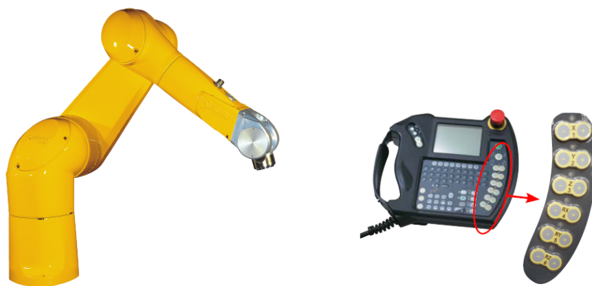
FIGURE 1.10 – Exemple de solution équipée d'une poignée avec capteurs (6-axis Articulated Robot, Star Automation Europe)
