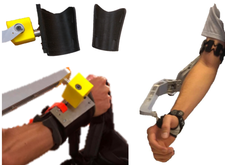
FIGURE 4.15 – Comparaison de la nouvelle (à droite) et de l'ancienne (à gauche) attache
