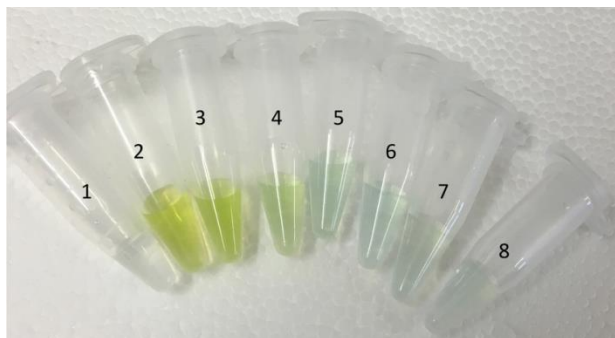
Figure 100 : Fractions 1 à 8 obtenues après filtration sur une colonne de Sephadex™ G75 de la suspension de liposomes couplés à l'aptamère H02.
