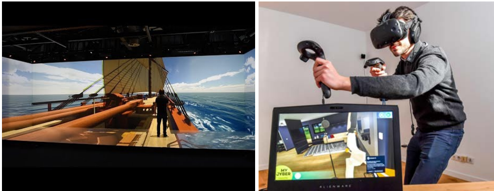
Figure 8.2 – Exemples des deux principaux systèmes d’affichage visuel pour expérimenter la RV. A gauche : Un utilisateur immergé dans le cave Immersia à Rennes, France. A droite : Un homme utilise un visiocasque et des joysticks dans les bureaux de MCR à Lille, France. Philippe Huguen / AFP - Getty Images file
