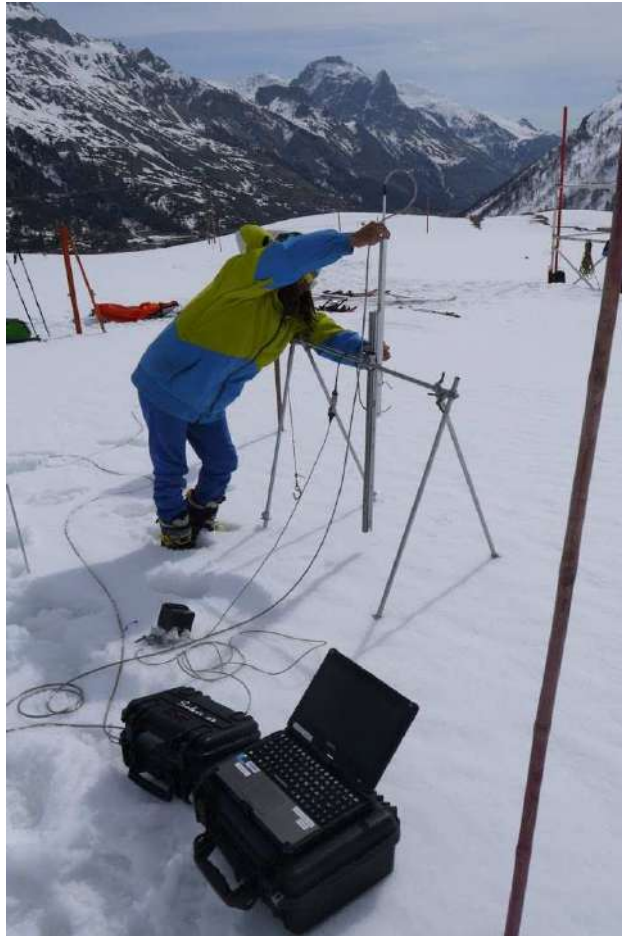
FIGURE 3.11 – Instrument de mesure des profils d'irradiance spectrale : SOLEXS. La tige, installée sur le trépied, au bout de laquelle se trouve un collecteur de lumière, est insérée dans le manteau neigeux. Elle est connectée par fibre optique au spectromètre qui se trouve dans le boîtier noir de gauche. Ce boîtier est également connecté à l'ordinateur durci de terrain (à droite) qui permet de visualiser l'acquisition. Crédit photo : Jacques Roule
