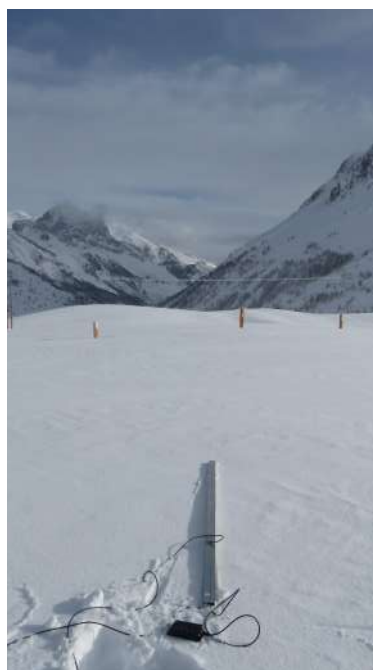
FIGURE 3.10 – Détermination de la pente et de l'azimuth de la surface sous une mesure d'albedo. 10/01/2018
