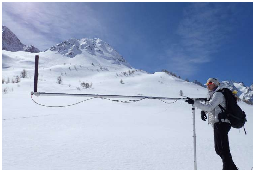
FIGURE 3.9 – Mesure du rayonnement solaire diffus avec l'instrument Solalb en cachant le rayonnement solaire direct par une fine languette métallique. Crédit photo : Clément Delcourt.
