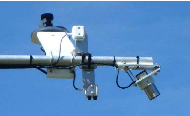
Capteurs de NDVI
