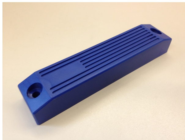
FIGURE 1.13 – Transpondeur RFID actif classique dans son boîtier
