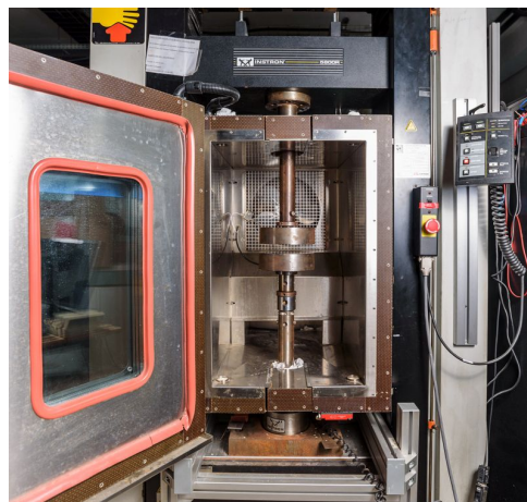
Figure II.13 – Dispositif de compression : enceinte climatique Servathin montée sur une machine d’essais Instron 5800. Un hygromètre permet de suivre l’humidité et la température.
