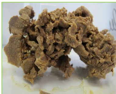
Figure 38 : photographie du xérogel de référence séché à 150°C pendant 4 h (Ce/Gd).
