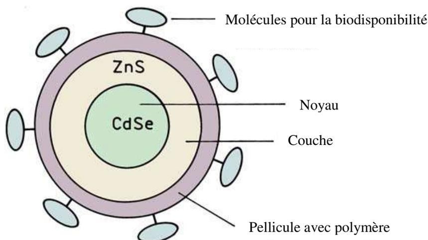
**Figure 13.** Représentation schématique d'un QD avec une surface biocompatible
