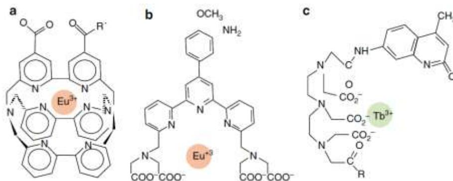
**Figure 16.** Structures typiques des complexes chélateurs avec Eu (III) et Tb (III). Pour les cryptates (a) et la terpyridine (b) le chélate et l'antenne font partie de la même entité. Le complexe peut être aussi composé d'un groupe chélateur et d'une antenne positionnés séparément (c)<sup>167</sup>
