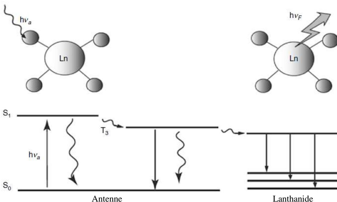
**Figure 17.** Processus à l'état excité dans les complexes de lanthanides. Les photons sont absorbés par les ligands aromatiques et après conversion  $S_1 - T_3$ , l'énergie est ensuite transférée vers l'ion du lanthanide qui va émettre de la lumière
