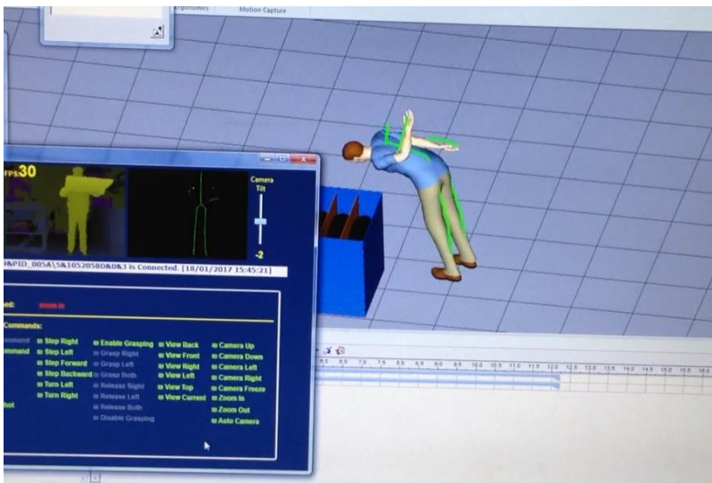
Figure 43 Exemple de déformation de posture du mannequin lors d'un masquage de point de repère sur une capture de mouvement par Kinect
