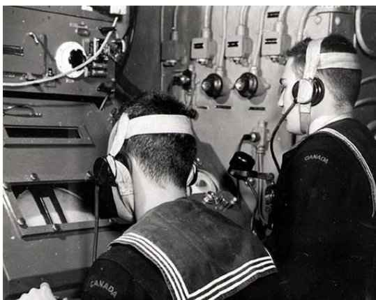
Figure 2.21 : Le système ASDIC (Anti-Submarine Detection Investigation Committee) utilisé par la Royal Navy lors de la Seconde Guerre Mondiale est basé sur l'acoustique active afin de détecter les sous-marins allemands.
