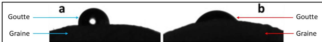
Figure I-15 : Photo du test d'angle de contact. Figure extraite de Dobrin et al., 2015 [4]. a : surface de graine témoin ; b : surface de graine traitée au plasma
