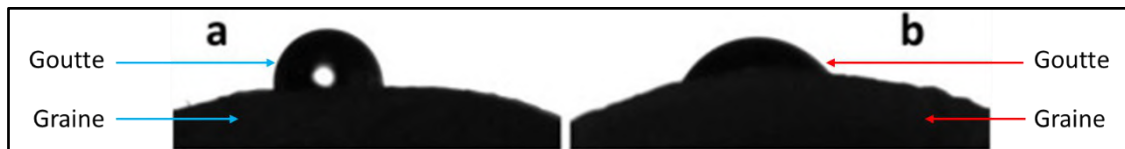
Figure I-15 : Photo du test d'angle de contact. Figure extraite de Dobrin et al., 2015 [4]. a : surface de graine témoin ; b : surface de graine traitée au plasma
