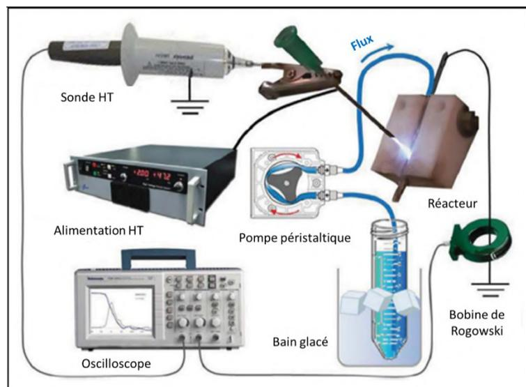
**Figure I-11** Schéma du dispositif de l'étude de Kučerová en 2019 servant l'activation de l'eau. Ce dispositif est basé sur un appareil de Type DBD mais l'échantillon traité est ici de l'eau. L'électrode, présente au fond d'une gouttière va permettre à l'eau d'être traitée à son passage. De plus, une pompe permet de fermer le circuit d'eau afin de contrôler le nombre de passage sous le plasma.
