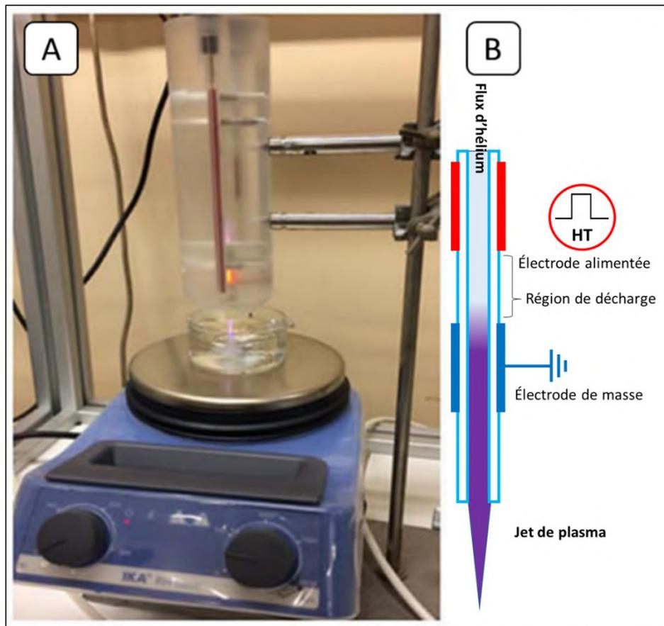
**Figure II-7** Aperçu sur l'installation utilisée pour activer l'eau à l'aide du jet de plasma d'Helium. Photographie de l'installation (A): la distance entre la sortie du tube et la surface de l'eau placée dans le bécher est fixée à 2 cm. Le bécher est posé sur un agitateur magnétique permettant de remuer régulièrement l'eau pendant les 15 min de son traitement par plasma. Schéma du dispositif de jet de plasma d'hélium (B).
