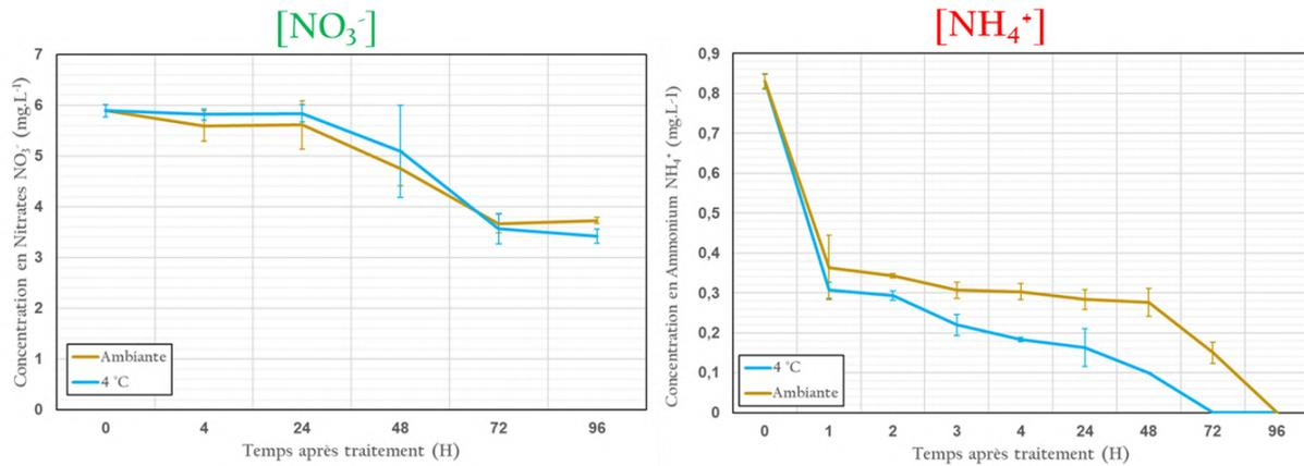
**Figure III-15 : Courbe de l'évolution de la concentration en ammonium et nitrates en fonction du temps et du stockage dans l'eau du robinet activée par plasma PAW<sub>Tap</sub>.**
