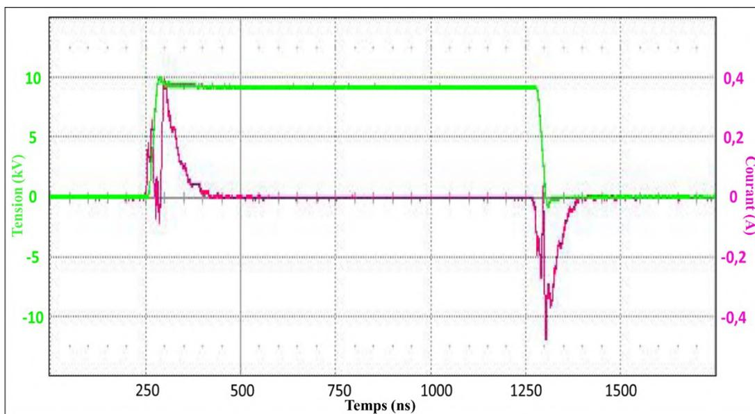
**Figure II-4 : Courant et tension instantanés de la décharge DBD dans l'hélium générant le jet de plasma. À noter que le courant inclut aussi le courant de déplacement (première bosse lors de la montée) issue de [65]**
