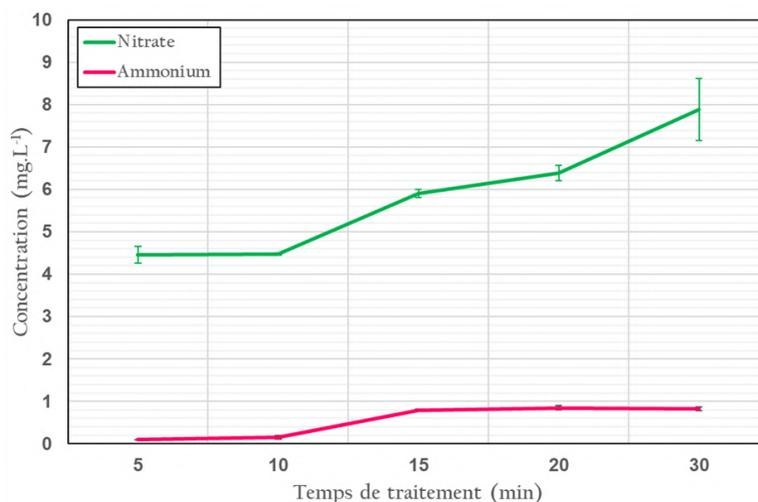
**Figure III-16 : Courbe des concentrations en ammonium et nitrate en fonction du temps d'exposition au jet de plasma d'hélium dans l'eau activée par plasma PAW<sub>Tap</sub>. La courbe verte représente la concentration en NO<sub>3</sub><sup>-</sup> et la courbe rose la concentration en NH<sub>4</sub><sup>+</sup> en mg.L<sup>-1</sup>.**
