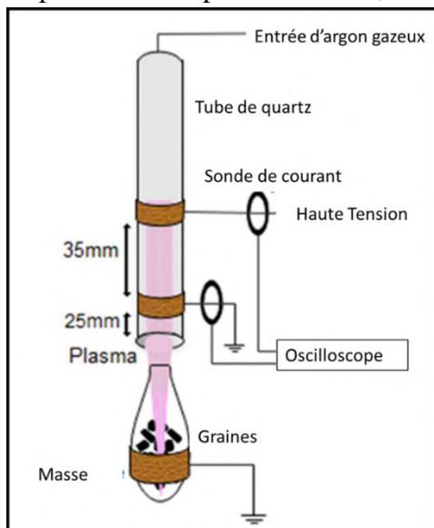
**Figure I-10 Schéma du jet plasma adapté de Fadhlalmawla et al., 2019.** Le principe du jet plasma est similaire à celui de la DBD cependant ici le gaz plasmagène est ionisé entre les électrodes se trouvant à l'intérieur du tube de quartz avant d'en être éjecté à l'extérieur du tube pour être utilisé pour le traitement des graines. Grâce au flux de gaz, on peut observer une plume plasma qui vient au contact des graines.
