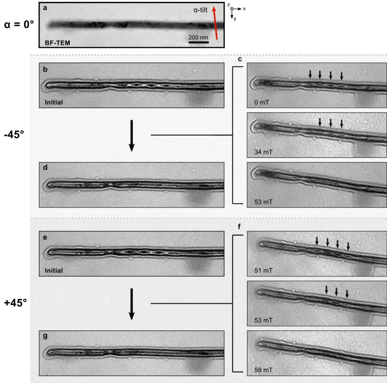
Figure 7.10: Résultats de l'application du champ magnétique *in situ* le long de l'axe des nanofils. (a) Image MET en champ clair du nanofil étudié, où la flèche rouge indique l'axe d'inclinaison  $\alpha$ . (b)-(g) Images de Fresnel montrant le changement de configuration magnétique par rapport au champ appliqué le long de l'axe nanofil dans les directions  $x$  positive et négative en répétant la mesure à  $-45^\circ$  (b)-(d) et  $+45^\circ$  (e)-(g)  $\alpha$ -tilt.
