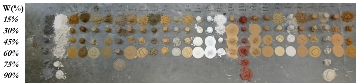
Figure I-5: Matrice de consistance inspirée du "test Carazas" réalisée sur 28 terres bretonnes et normandes différentes [35] (Crédit photo : Théo Vincelas)
