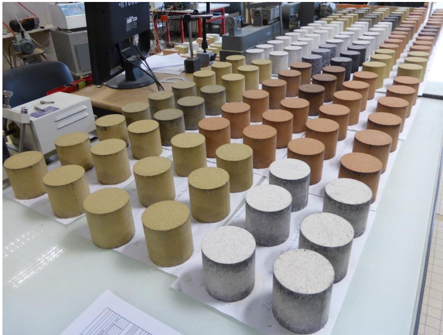
Figure IV-28: Éprouvettes compactées et vibro-compactées de différentes formulations des terres K, R et S
