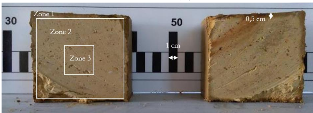
Figure V-39: Évolution du front d'humidification après deux heures d'immersion dans un cube 100*100*100mm 3 de la formulation Terre S+HMP+Xan(0,5%)
