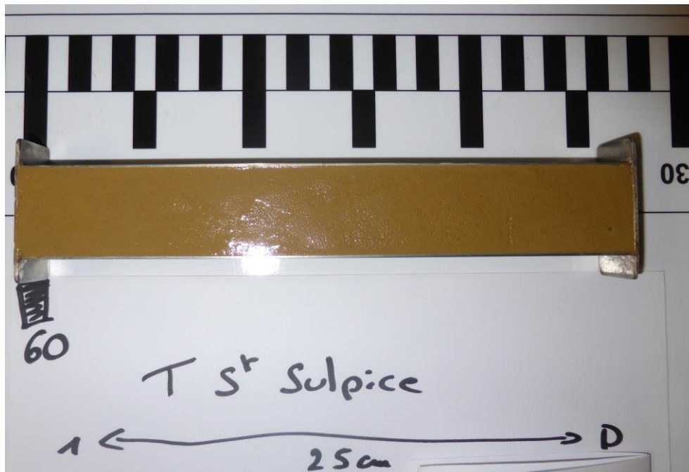
Figure II-5: Dispositif de mesure du retrait linéique sur la terre S
