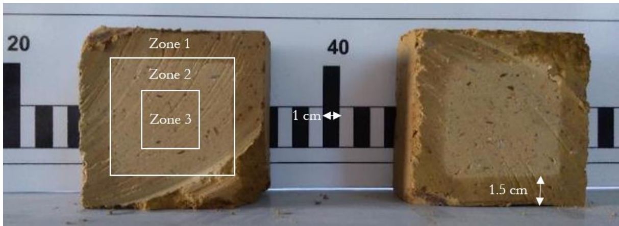
Figure V-38: Évolution du front d'humidification après deux heures d'immersion dans un cube 100*100*100mm 3 de la formulation Terre S+HMP+HDL(2%)
