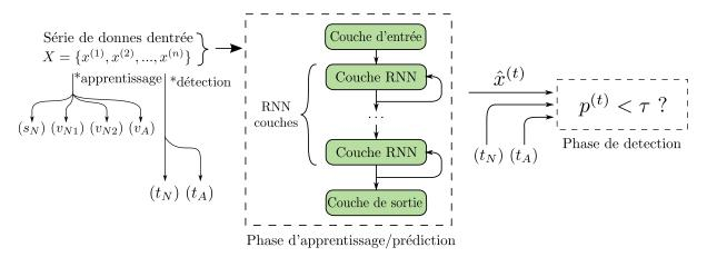
Figure 11: Model de détection avec réseau RNN
