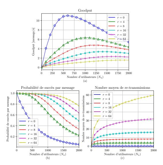
**Figure 6:** Performance de LoRaWAN avec re-transmission considérant des limites matérielles et des canaux réalistes: (a) *Goodput*, (b) Probabilité de succès par message et (c) Nombre moyen des re-transmissions.
