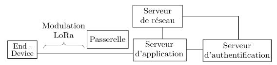
Figure 2: Architecture de LoRaWAN
