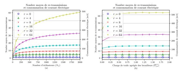
Figure 10: Consommation de courent électrique moyenne et nombre moyen de re-transmissions : (a) pas de jamming, (b) jamming dans la voie montante.
