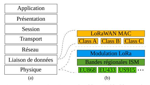
Figure 1: Pile protocolaire du LoRaWAN : (a) modèle OSI, (b) LoRaWAN
