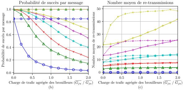
Figure 7: Performance d'un réseau LoRaWAN avec brouilleurs et  $N_u = 100$ : (a) Goodput, (b) Probabilité de succès par message and (c) Nombre moyen de re-transmissions.
